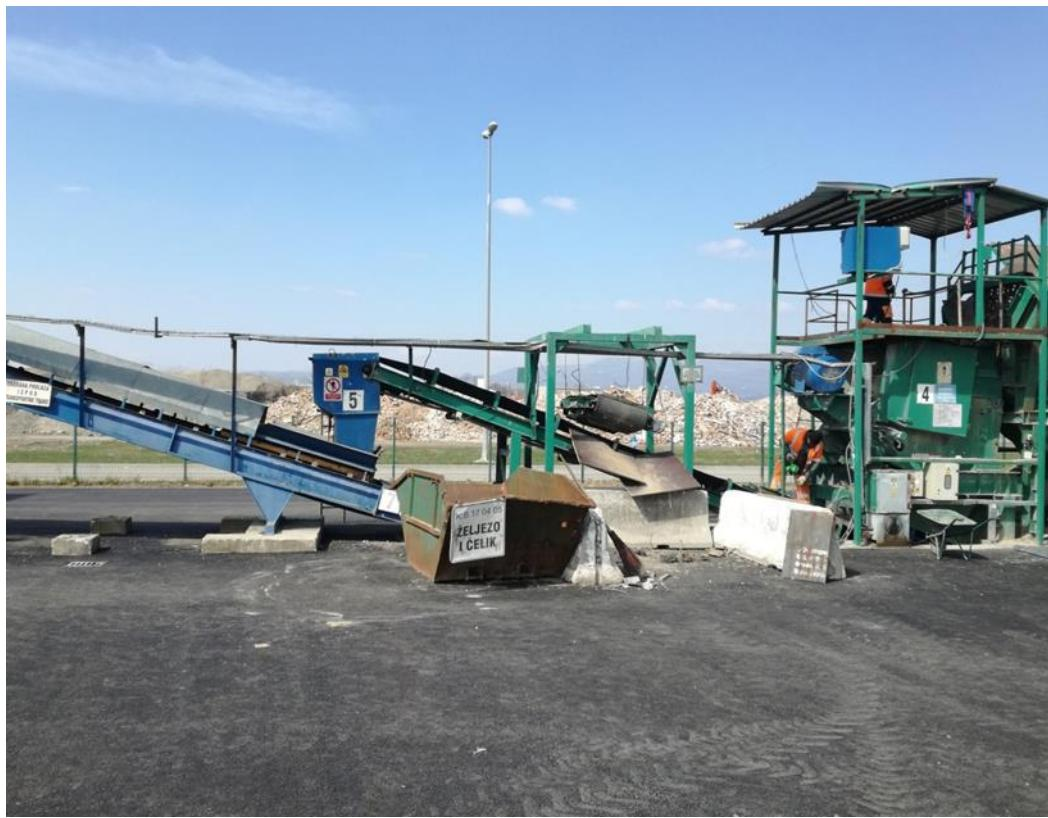
Slika 3-3.Bubnjasti magnetski separator za izdvajanje magnetične komponente
