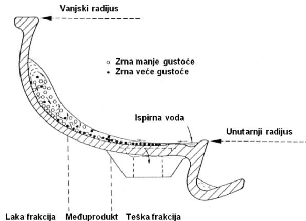
Slika 4-4. Spiralni žlijeb: raspored zrna u poprečnom presjeku žlijeba (Sobota, 2015).
