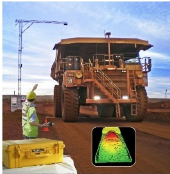
Slika 3-7. Skeniranje i mjerenje praznih i punih sanduka kamiona (Lang, 2010)
