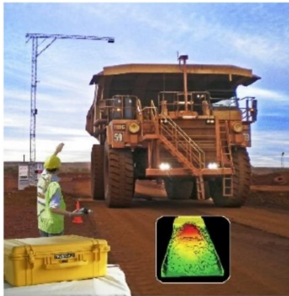
Slika 3-7. Skeniranje i mjerenje praznih i punih sanduka kamiona (Lang, 2010)
