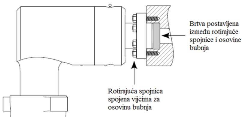
**Slika 4-6.** Rotirajuća spojница (Schlumberger Dowell, 1995)
