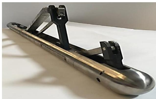
**Slika 6-3.** Fotografija traktora smanjenog promjera(Saeed et al., 2018)
