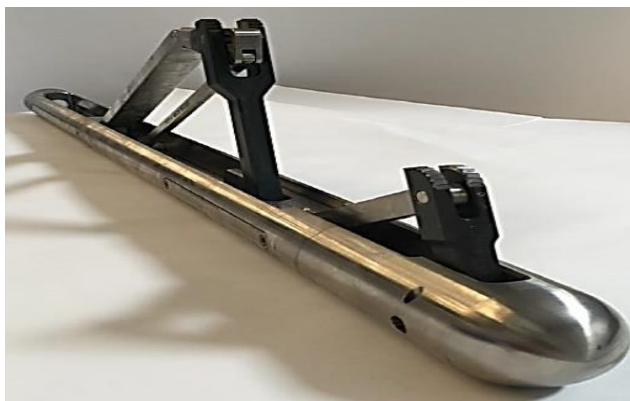
Slika 6-3. Fotografija traktora smanjenog promjera(Saeed et al., 2018)
