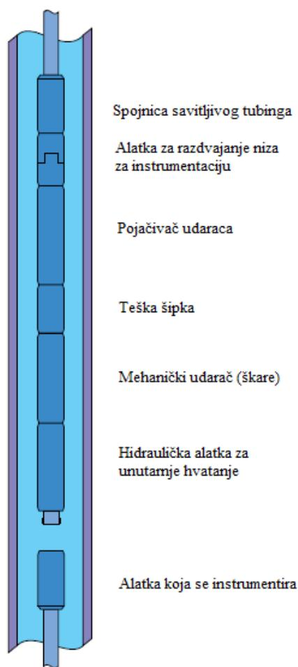
**Slika 5-14.** Uobičajeni dubinski sklop alata za instrumentaciju (CTES, 2005)
