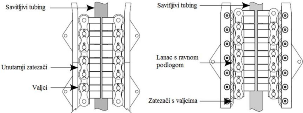
**Slika 4-15.** Različite izvedbe lanaca i zatezača u injektorskom sklopu (Schlumberger Dowell, 1995)
