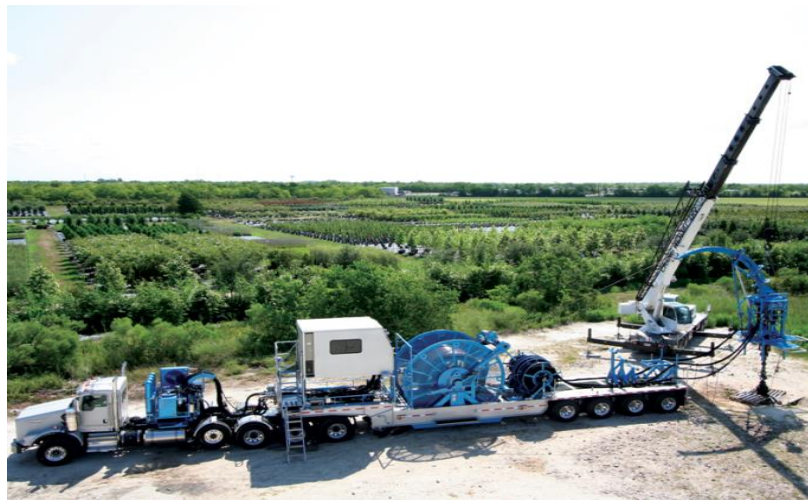
Slika 4-3. Postrojenje postrojenje za rad sa savitljivim tubingom montirano na prikolici (Stewart and Stevenson, 2018)
