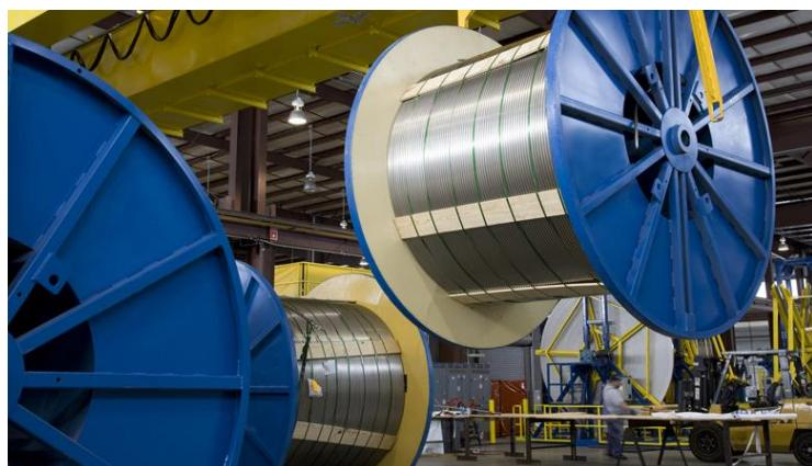
**Slika 3-6.** Čelične trake željenih dimenzija (Webco Industries, 2018)
