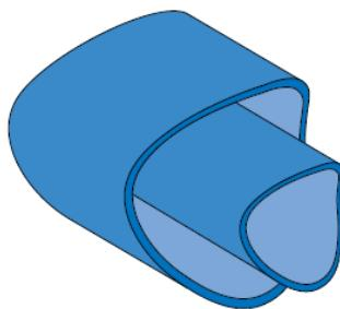
Slika 5-4. Presjek koncentričnog savitljivog tubinga (CTES, 2005)
