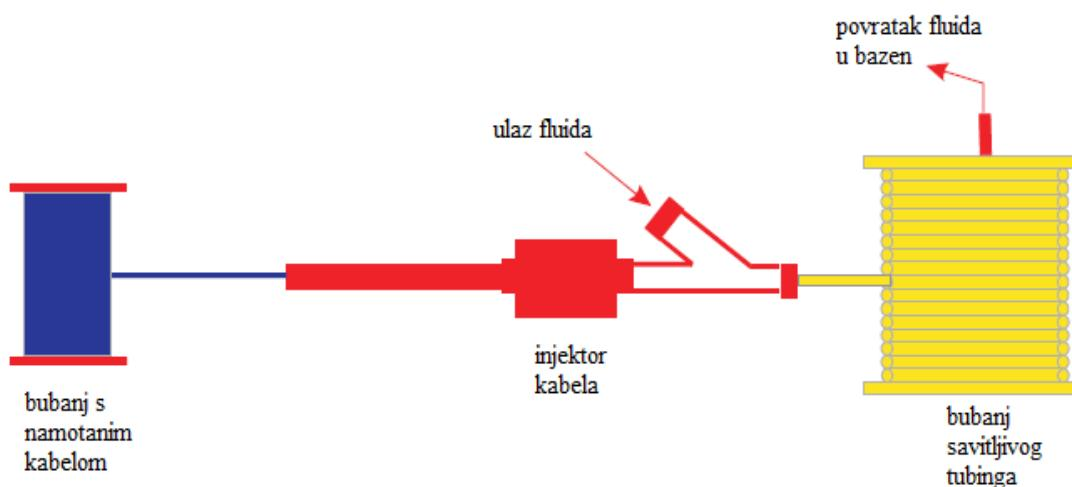
**Slika 5-24.** Injekcijski sustav za uvlačenje električnog kabela u niz savitljivog tubinga (CTES, 2005)
