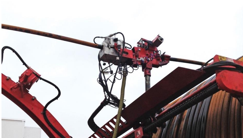
Slika 4-10. Mjerač duljine tubinga (Drilling Contractor, 2018)
