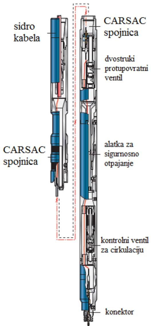
**Slika 5-25.** Dubinski sklop alatki savitljivog tubinga za provođenje karotažnih ispitivanja tvrtke NOV Coiled Tubing Tools (National Oilwell Varco, 2016)
