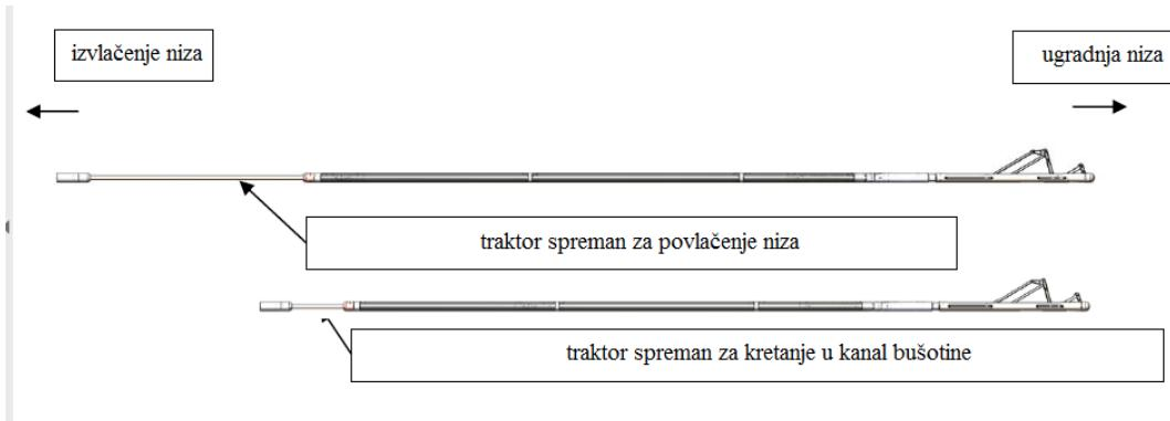
**Slika 6-2.** Shema kretanja traktora (Saeed et al., 2018)
