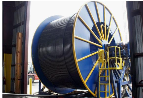
**Slika 3-10.** Novi savitljivi tubing (OCTG Pipes Products, 2015a)
