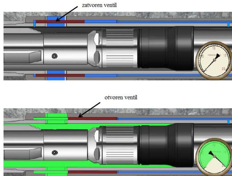
Slika 5-28. Postupak otvaranja kliznog rukavca (Castro et al., 2013)
