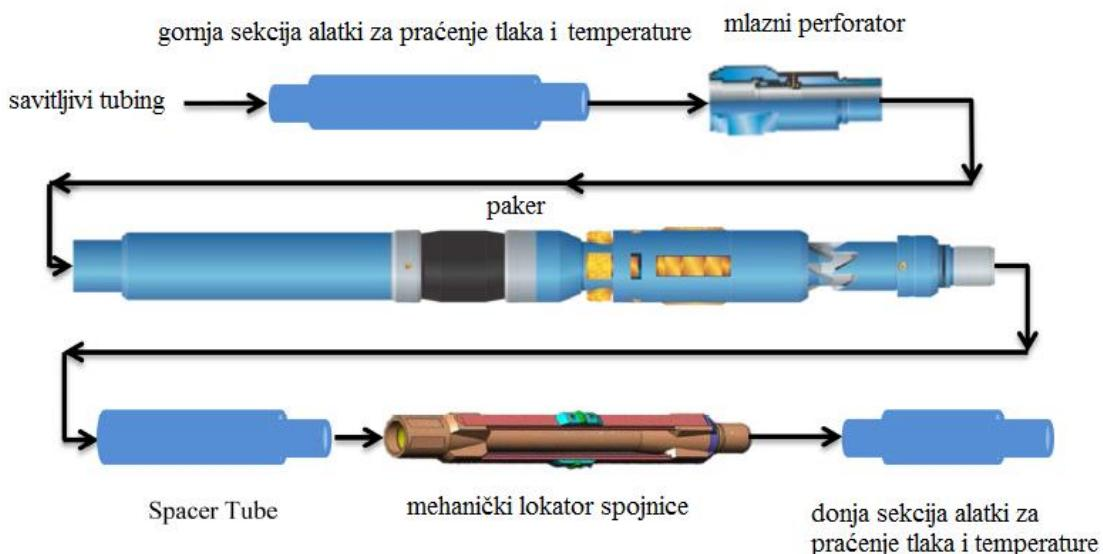
**Slika 5-26.** Dubinski sklop alatki za višestupanjsko frakturiranje uz primjenu niza savitljivog tubinga (Algadi et al., 2014)
