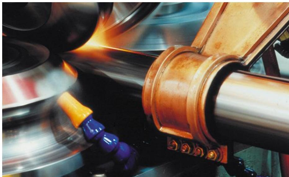
**Slika 3-9.** Indukcijski zavarivač (EFD Induction, 2018)
