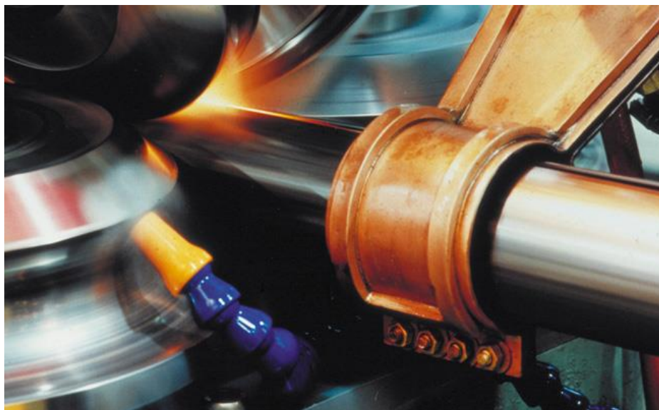
Slika 3-9. Indukcijski zavarivač (EFD Induction, 2018)
