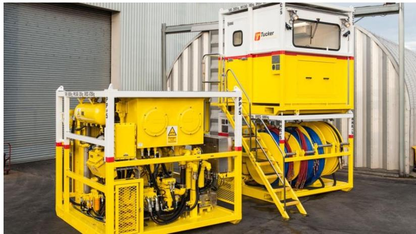
**Slika 4-22.** Pogonsko hidraulički regulacijski sklop (National Oilwell Varco, 2018f)
