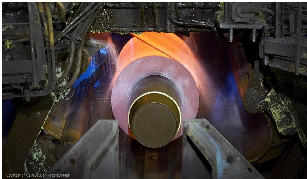
Slika 3-4. Postupak namatanja čelika (National Oilwell Varco, 2018a)
