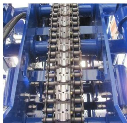
**Slika 4-16.** Tarni segmenti za obuhvaćanje određenog promjera (Power Hydraulics Engineering and Manufacturing, 2018)
