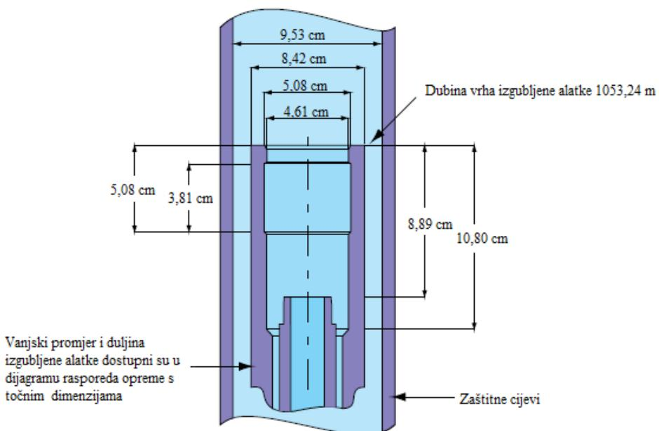
**Slika 5-12.** Primjer detaljnog opisa stanja stanja alatki zaostalih u bušotini neposredno prije provođenja operacije instrumentacije (CTES, 2005)
