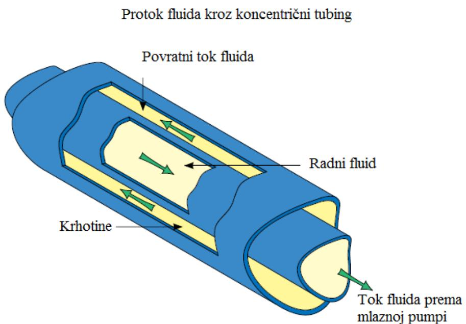
**Slika 5-5.** Tok fluida kroz koncentrični savitljivi tubing (CTES, 2005)
