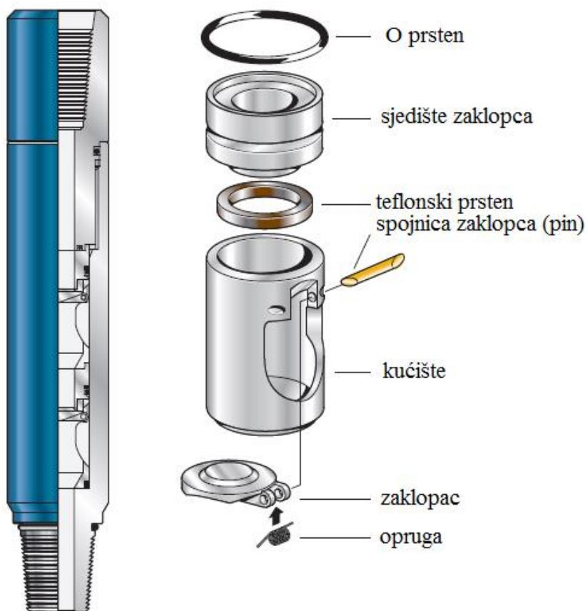
**Slika 5-8.** Dvostruki protupovratni ventil (National Oilwell Varco, 2016)
