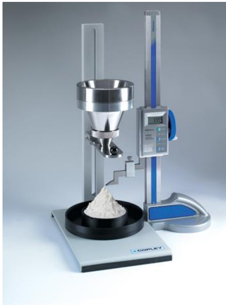
Slika 2- 2 Uređaj za metodu lijevka (AraChem, 2018)
