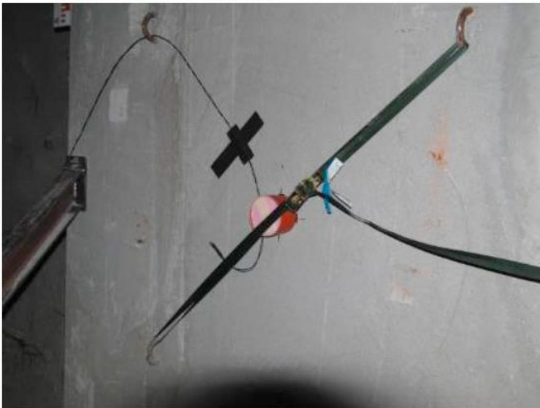
Slika 5-2. Prikaz postavljenog eksplozivnog naboja na testnoj betonskoj ploči (Zircher i dr., 2017)
