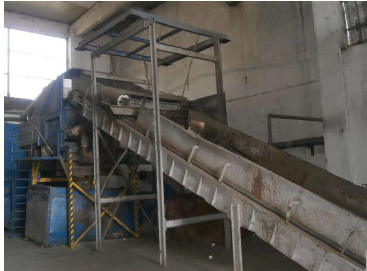
Slika 5-3. Zračni separator s magnetskim separatorom
