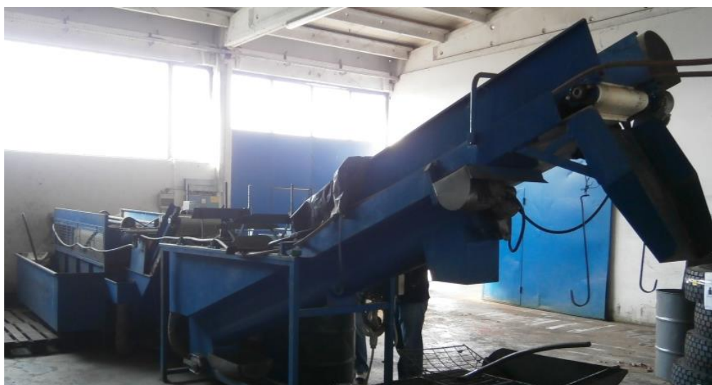
Slika 5-5. Separator za razdvajanje plastike i parafina
