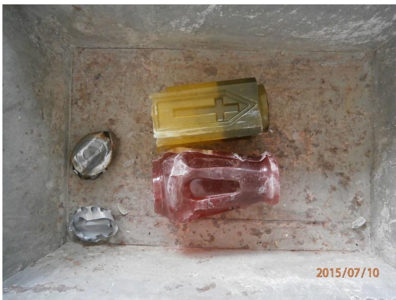
Slika 3-3. Lampioni nakon drobljenja u čeljusnoj drobilici
