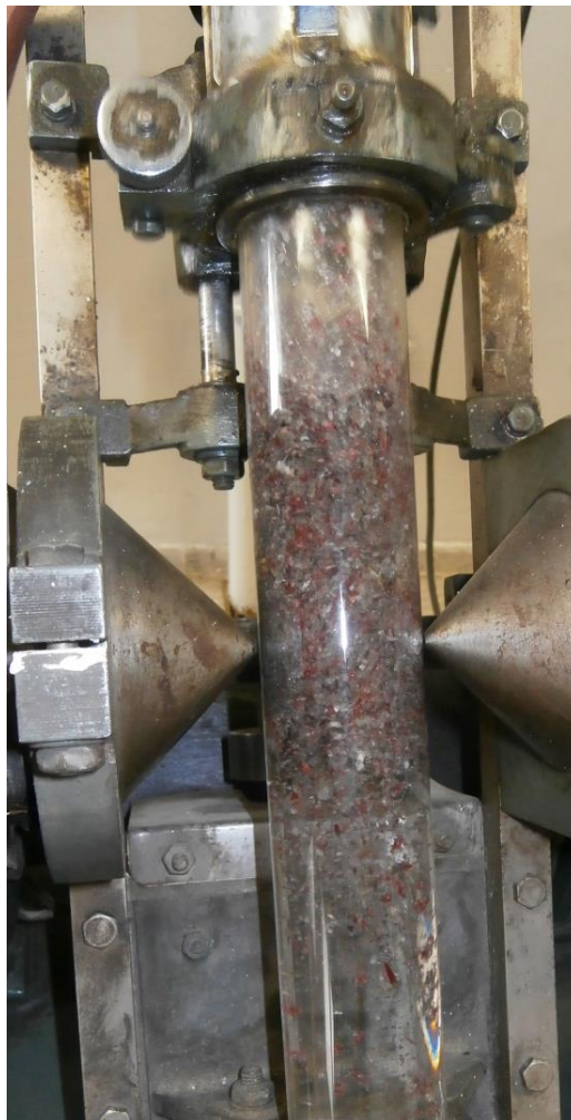
Slika 3-14. Materijal tokom magnetske separacije
