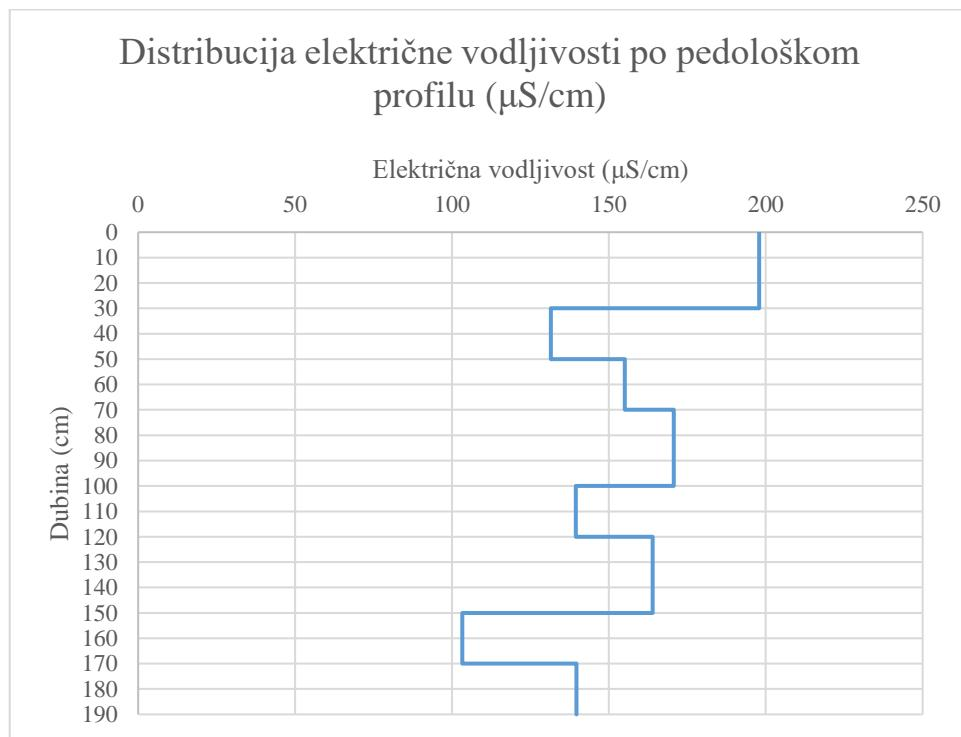
Slika 4.2. Distribucija električne vodljivosti po pedološkom profilu
