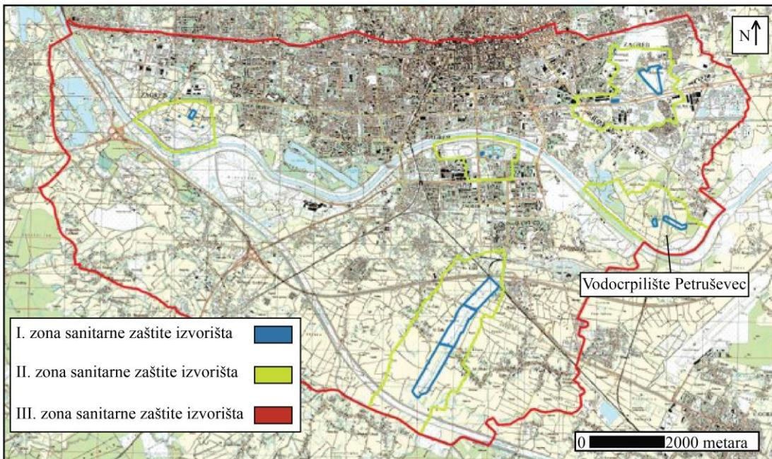
Slika 2.1. Prikaz zona sanitarnе zaštite izvorišta vodocrpilišta na području Zagreba (prilagođeno prema Programu mjera sanacije unutar zona sanitarnе zaštite izvorišta za postojeće građevine i postojeće djelatnosti, Grad Zagreb, 2016)
