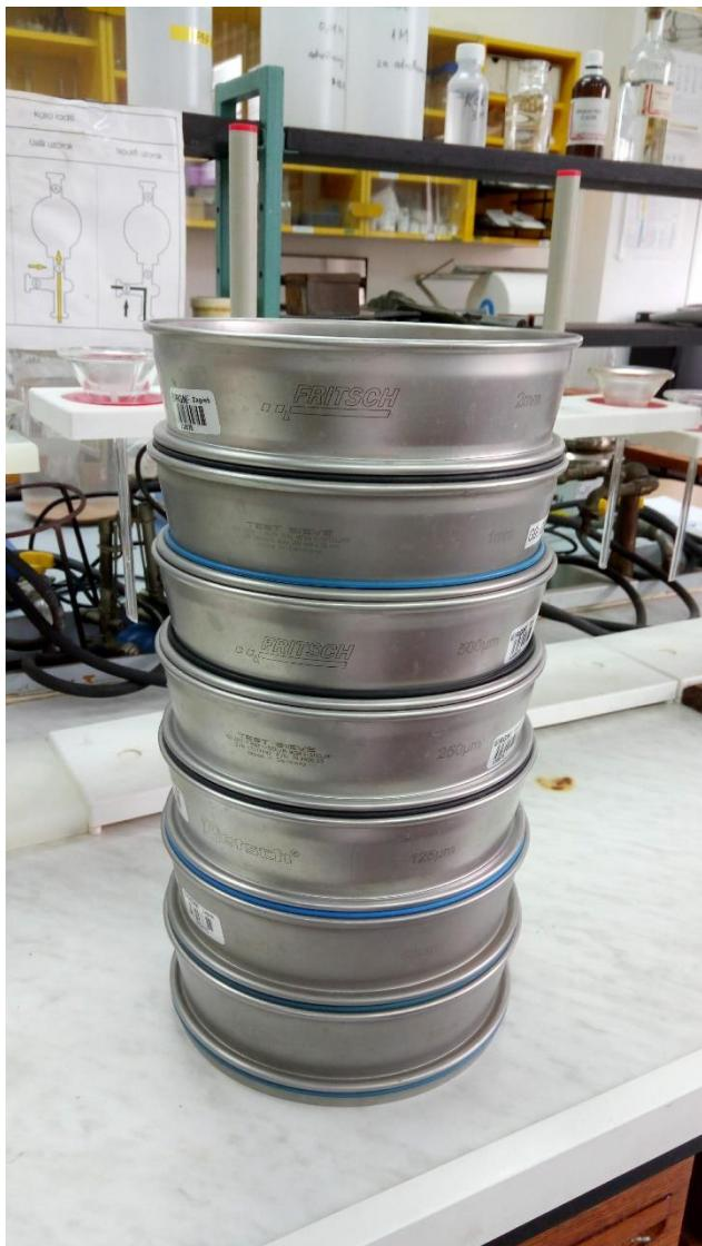
Slika 3.9. Kolona sita složena od najvećeg prema najmanjem promjeru otvora (foto: Borna-Ivan Balaž, 2018)
