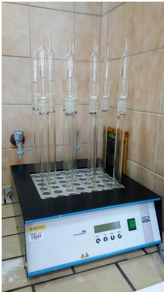
Slika 3.13. Epruvete na digestorskem bloku (foto: Borna-Ivan Balaž, 2018)
