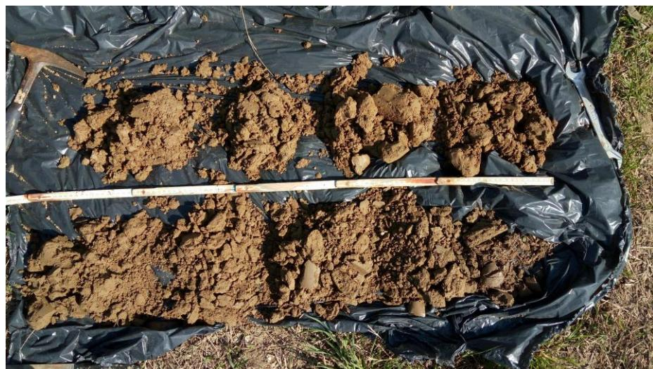
Slika 3.4. Raspoređivanje uzoraka po dubini (foto: Borna-Ivan Balaž, 2018)
