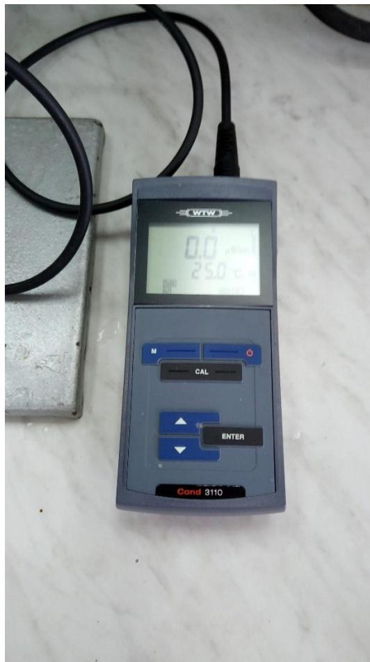
Slika 3.8. Konduktometar WTW Cond 3110 (foto: Borna-Ivan Balaž, 2018)
