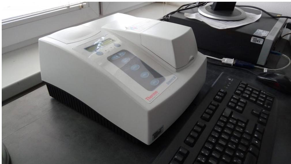
Slika 3.11. Spektrofotometar Thermo Scientific GENESYS 20 (foto: Borna-Ivan Balaž, 2018)
