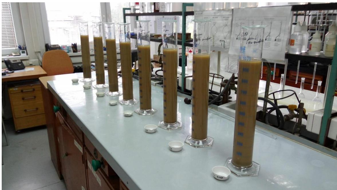
Slika 3.10. Cilindri ispunjeni najsitnijom frakcijom uzorka za potrebe pipetne metode
