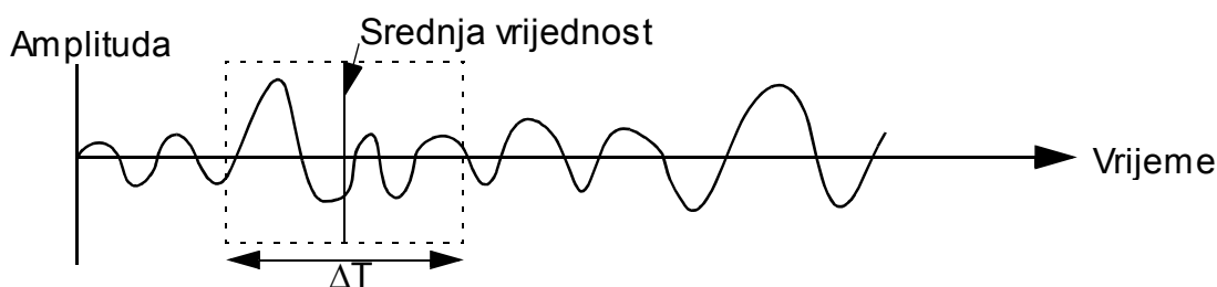
Slika 3-12 Princip AGC pojačanja
