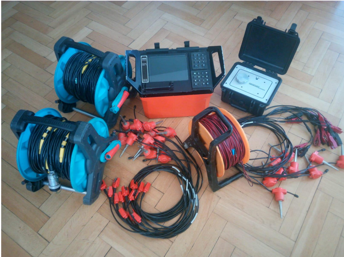
Slika 3-4 Digitalni 24 - kanalni seizmograf Terraloc Mk 6
