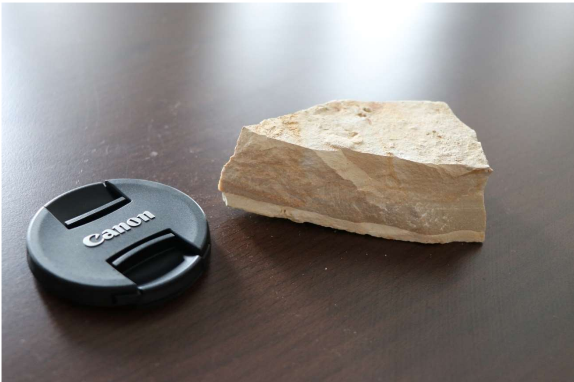
Slika 6.4. Uzorak kamena iz sloja 5 na kojem se jasno uočava tanka lamina mikrita (dolje) i deblji sloj zrnskog vapnenca (gore).
