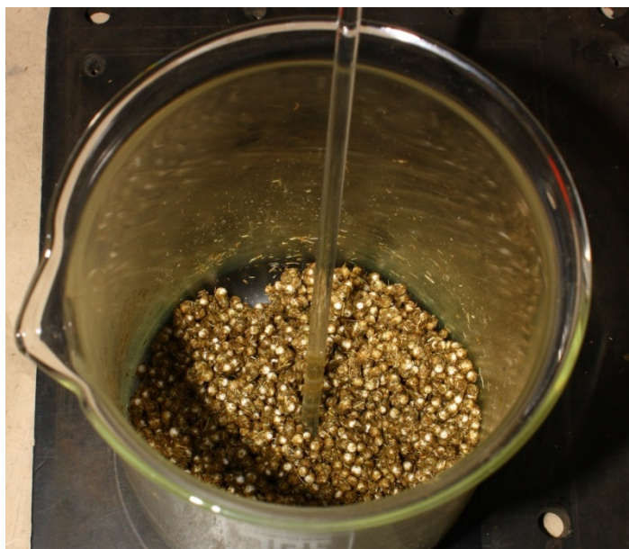
Slika 4-6. Eksplozivna smjesa emulzijske matrice sa EPS-om i usitnjenim sijenom
