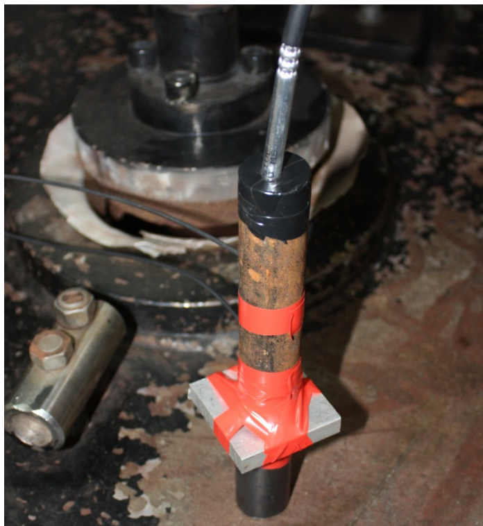
Slika 4-19. Postav za mjerenje probojnosti.
