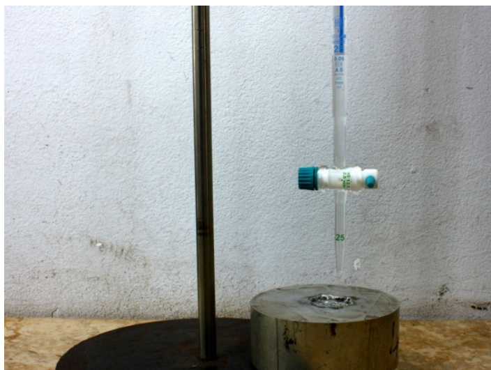
Slika 4-13. Mjerenje volumena otiska na aluminijskom cilindru.
