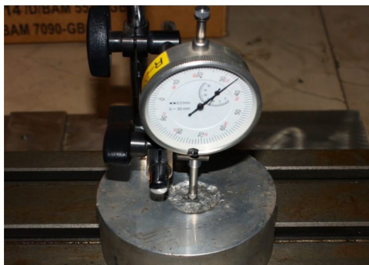
Slika 4-12 Mjerenje dubine otiska u aluminijskom cilindru mikrourom.
