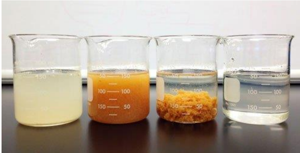
Slika 2-7 Koagulacija/flokulacija (Ecologix environmental system, 2018 )
