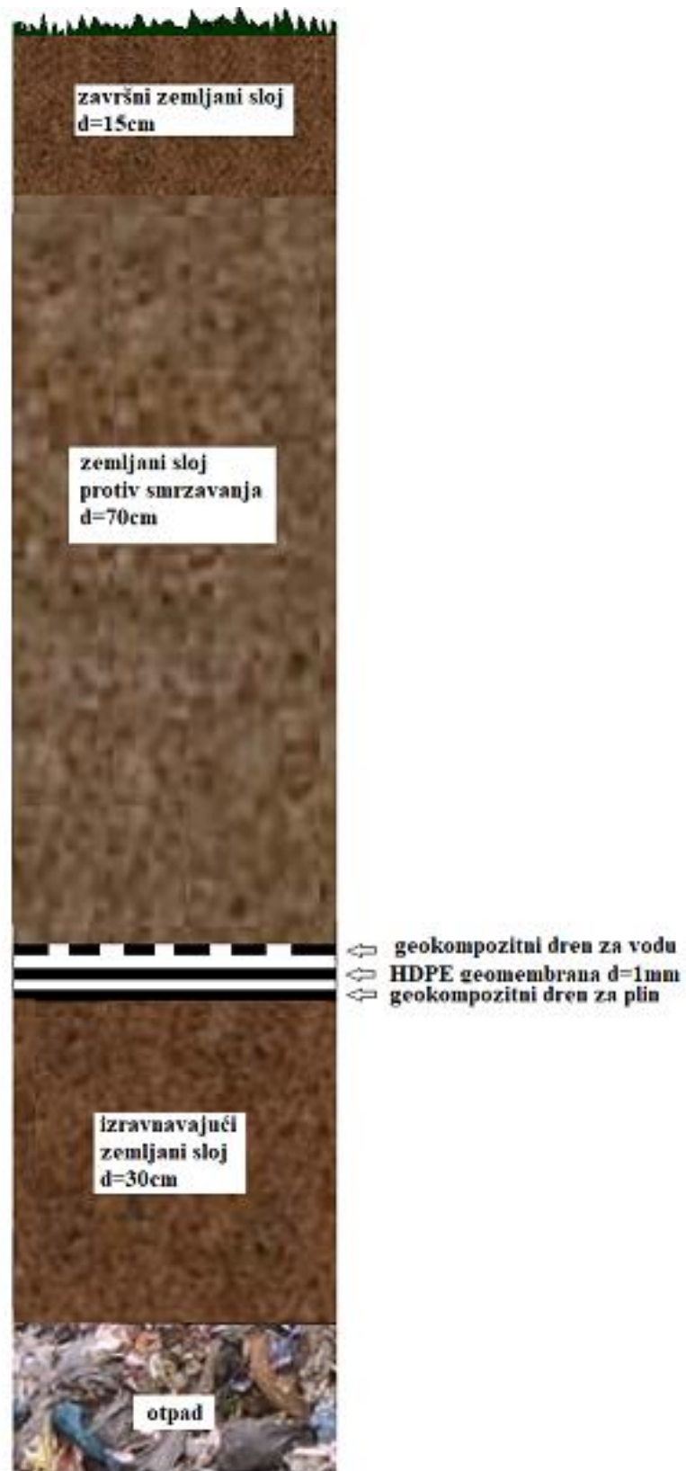
Slika 6. 3. Pokrovni sustav odlagališta otpada Tarno (prema H-PROJEKT 2008).
