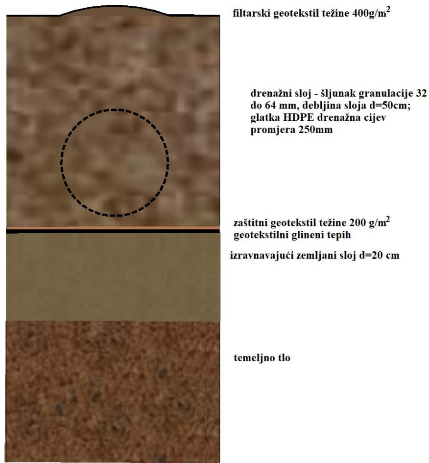
Slika 6. 2. Prikaz temeljnog brtvenog sloja plohe 6 postavljenog na odlagalište otpada Tarno (prema H-PROJEKT 2017).
