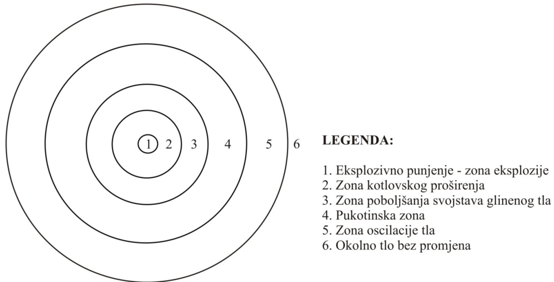
Slika 5.3 Djelovanje eksplozije u mekanim stijenama
