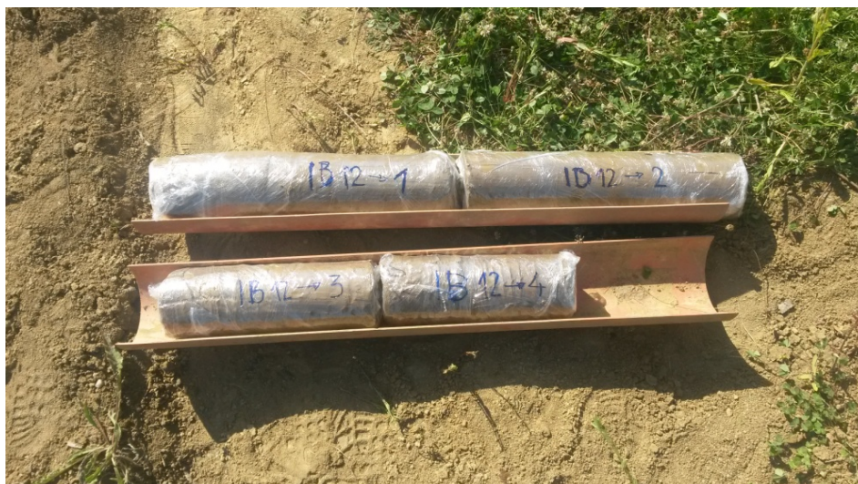
Slika 7.22 Izvađena jezgra na određenoj dubini
