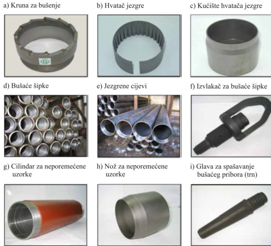
Slika 7.18 Pribor za bušenja s jezgrovanjem
