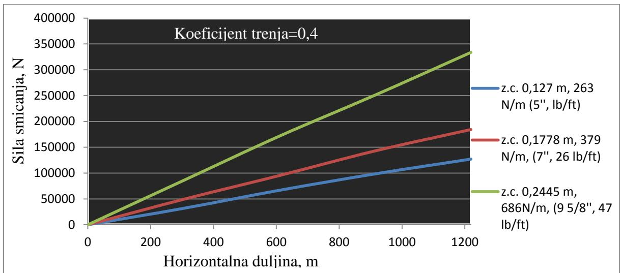
**Slika 5-5.** Otterećenje potrebno za potiskivanje zaštitnih cijevi kroz horizontalnu sekciju (El-Sayed et al., 1991)
