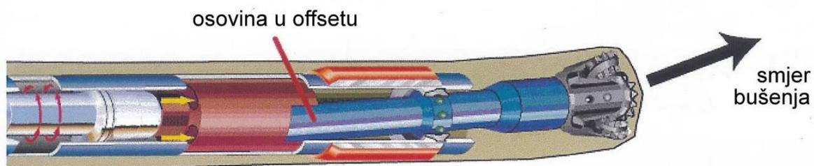
**Slika 4-10.** Način rada „point the bit“ sustava (Gaurina-Međimurec, 2014)
