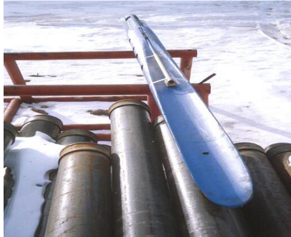
Slika 4-1. Primjer klina za skretanje (Gaurina-Međimurec, 2014)
