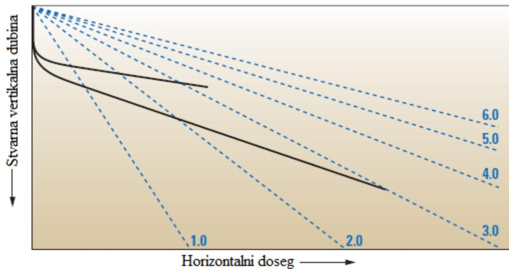
**Slika 1-2.** Osnovni tipovi horizontalnih bušotina velikog dosega (Bennetzen et al., 2010)
