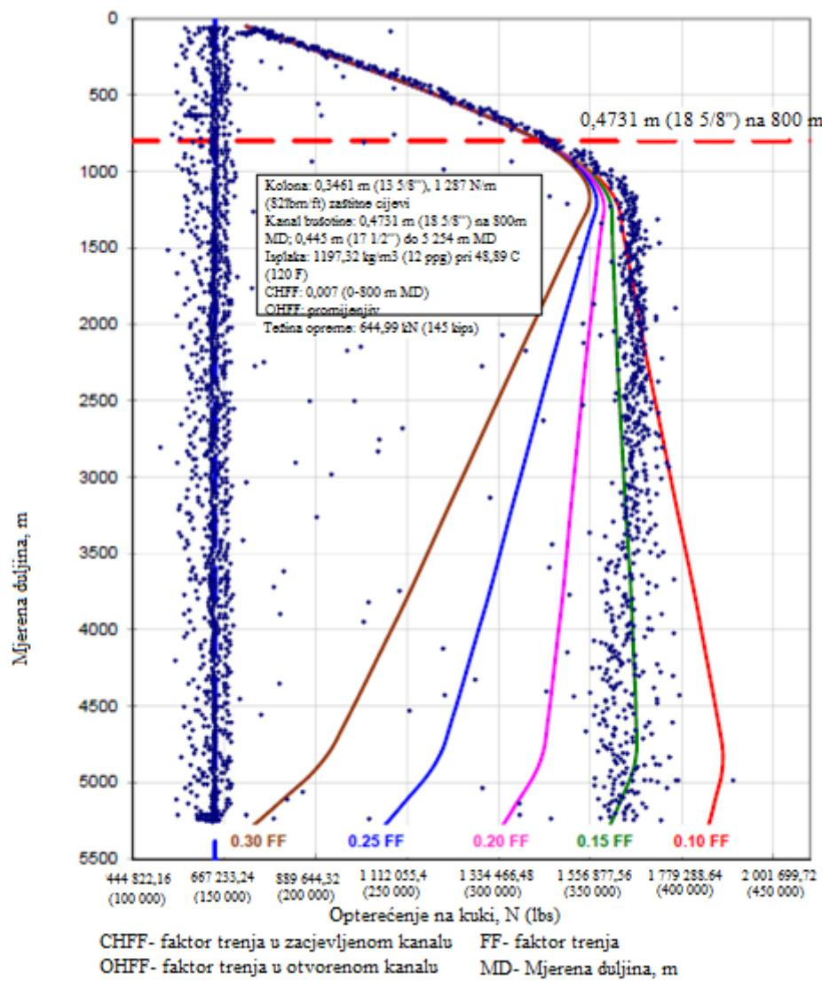
**Slika 6-6.** Smanjenje opterećenja na kuki tijekom ugradnje kolone zaštitnih cijevi promjera 0,3461 m (13 5/8 in.) (Walker, 2012)
