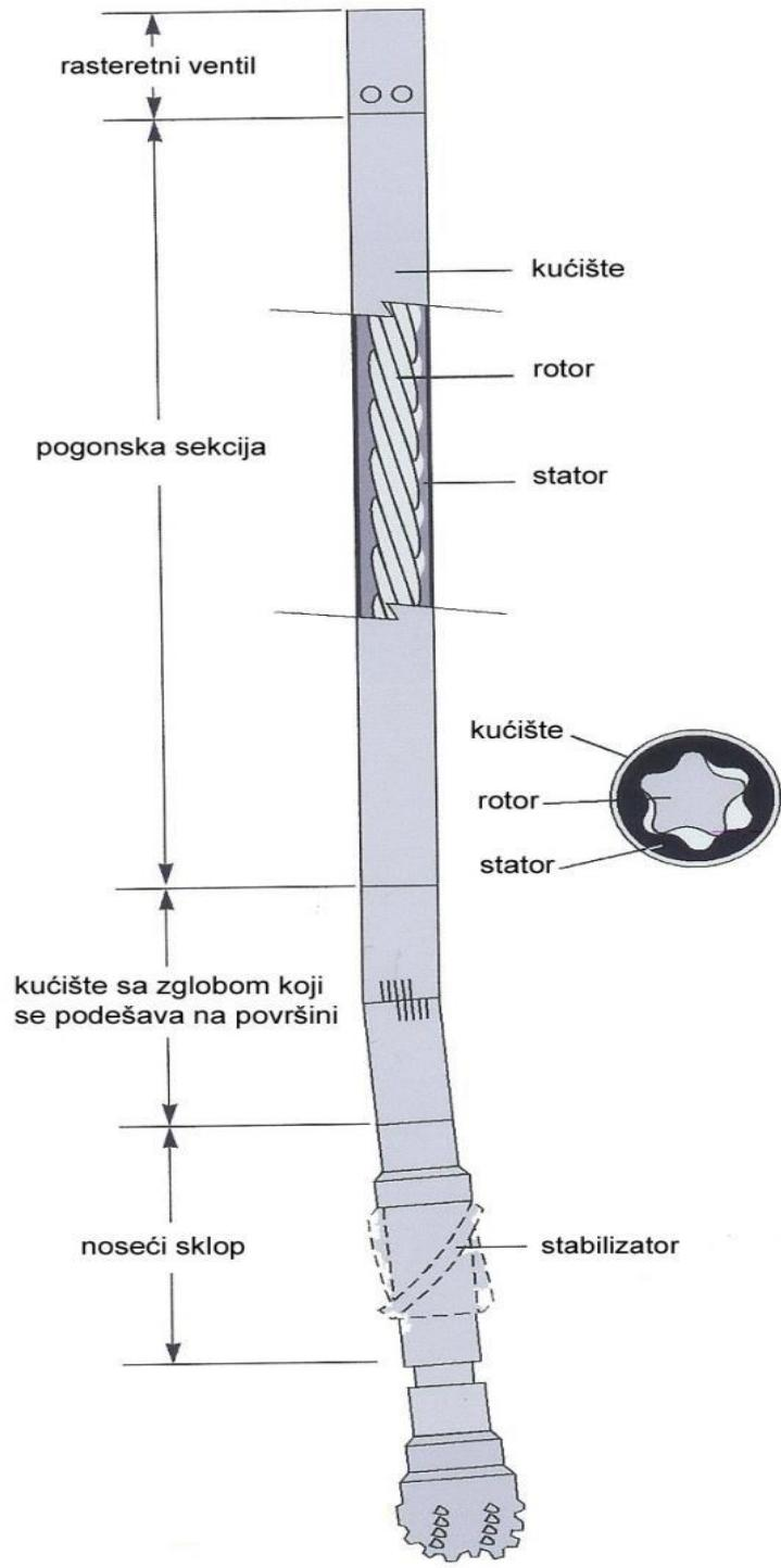
**Slika 4-6.** Upravljivi motor s podesivim kućištem (Gaurina-Međimurec, 2014)
