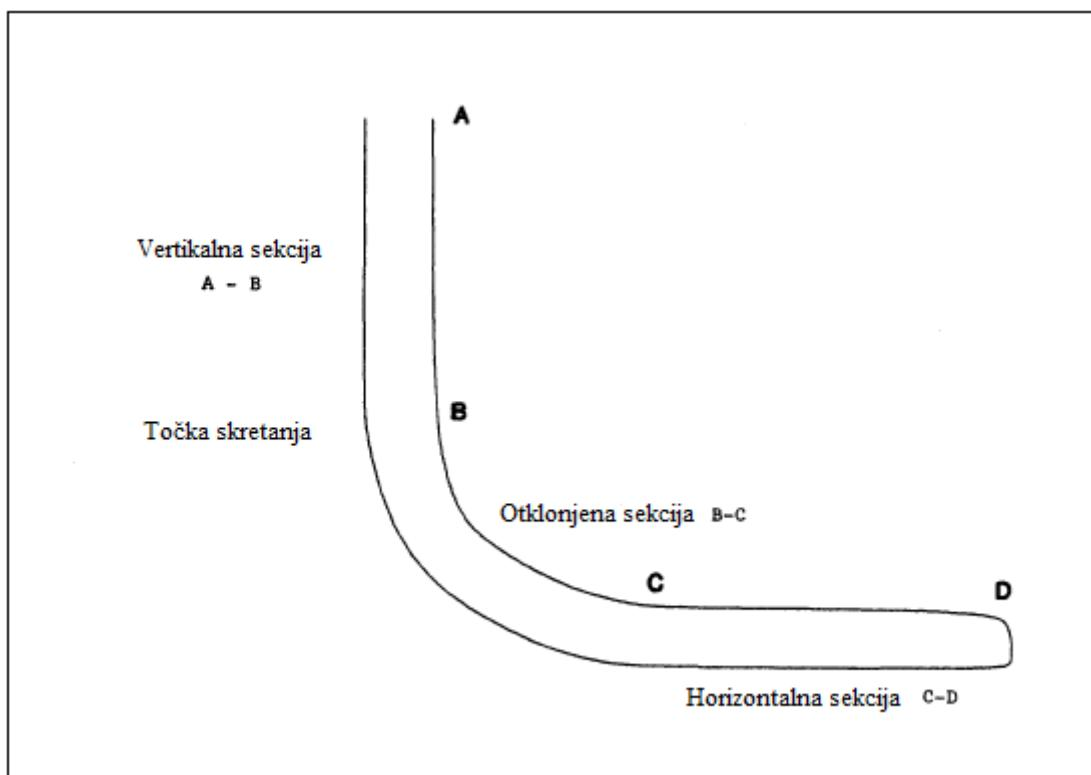
**Slika 5-1.** Dijelovi kanala horizontalne bušotine (El-Sayed et al., 1991)
