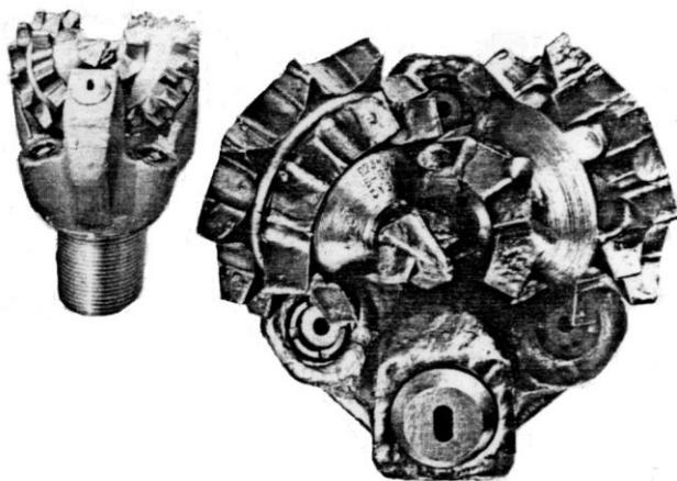
**Slika 4-3.** Dlijeto za usmjereni bušenje s produljenom mlaznicom (Gaurina-Međimurec, 2014)
