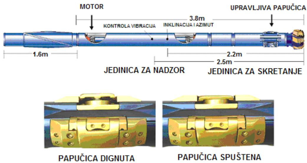
**Slika 4-9.** Način rada „push the bit“ sustava (Gaurina-Međimurec, 2014)
