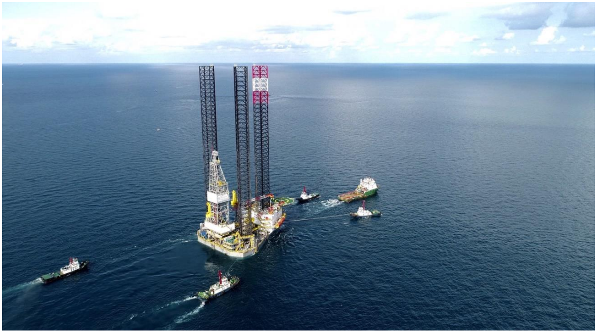
Slika 2-1. Tegljenje samopodižuće platforme (Charlton, 2014)
