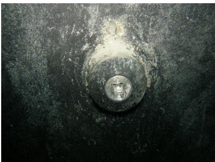
Slika 6-7. Mlaznice nakon čišćenja (Crosco, 2012)
