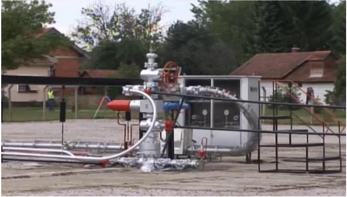
Slika 3-4. Fotografija tipične nadzemne opreme bušotina „Duboke Podravine“ (Tišljari et al., 2015).
