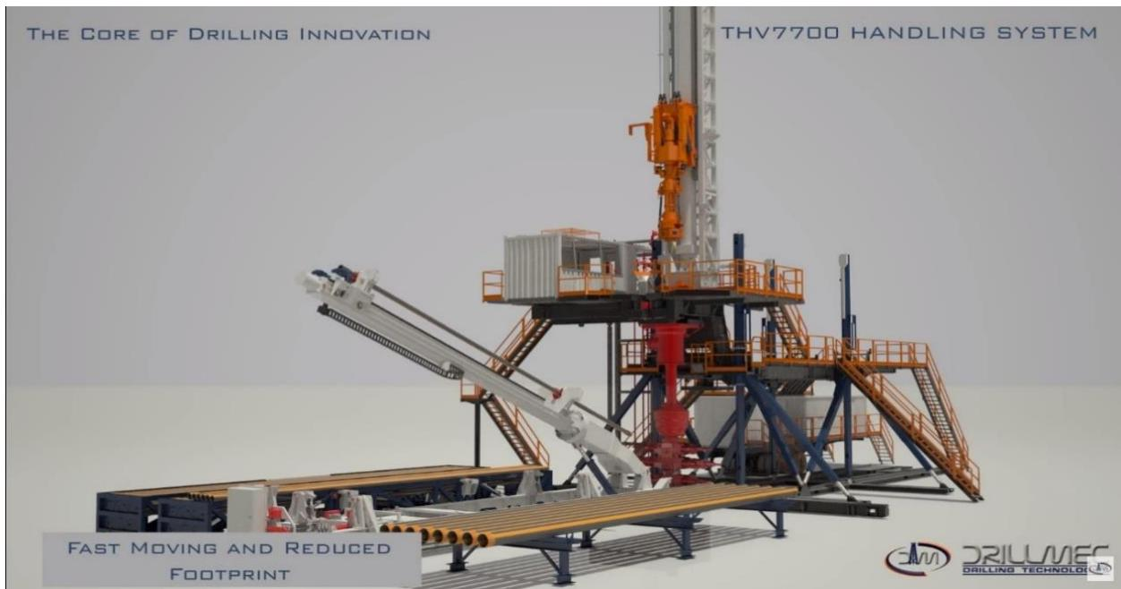
Slika 4-4. DRILLMEC THV 7700 daljinski upravljeni sustav za podizanje alatki (Drillmec, 2015)
