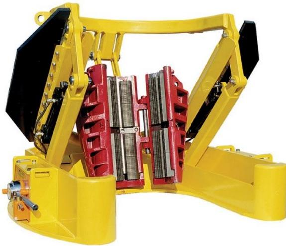
Slika 4-10. Sustav automatiziranih klinova s okvirom (Nov, 2010)
