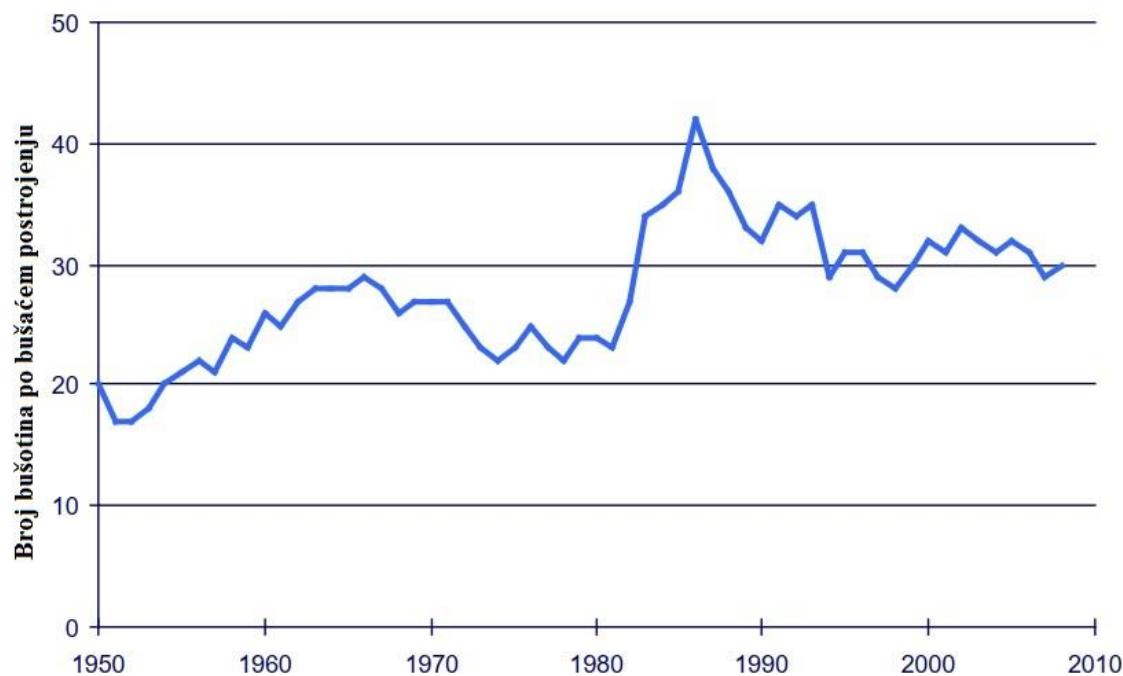
Slika 5-2. Efikasnost postrojenja iskazana u odnosu broja bušotina po bušaćem postrojenju u vremenskom razdoblju od 1950. godine do 2010. godine (EIA, 2010)
