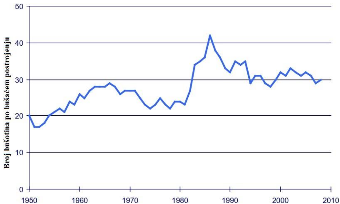
Slika 5-2. Efikasnost postrojenja iskazana u odnosu broja bušotina po bušačem postrojenju u vremenskom razdoblju od 1950. godine do 2010. godine (EIA, 2010)
