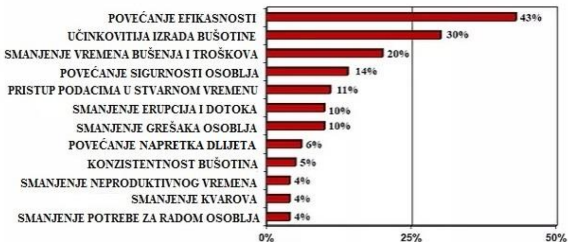
Slika 7-1. Razlozi korištenja automatiziranih bušaćih postrojenja (Kimberlite, 2017)
