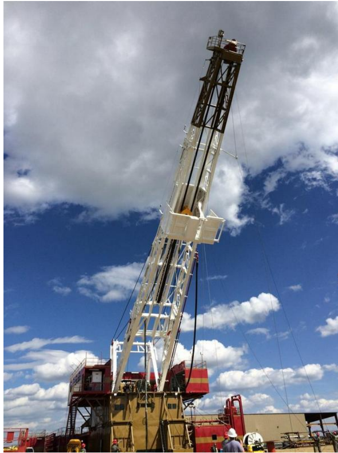
Slika 3-2. Podizanje preklopnog tornja kopnenog bušačeg postrojenja (Citadel, 2014)
