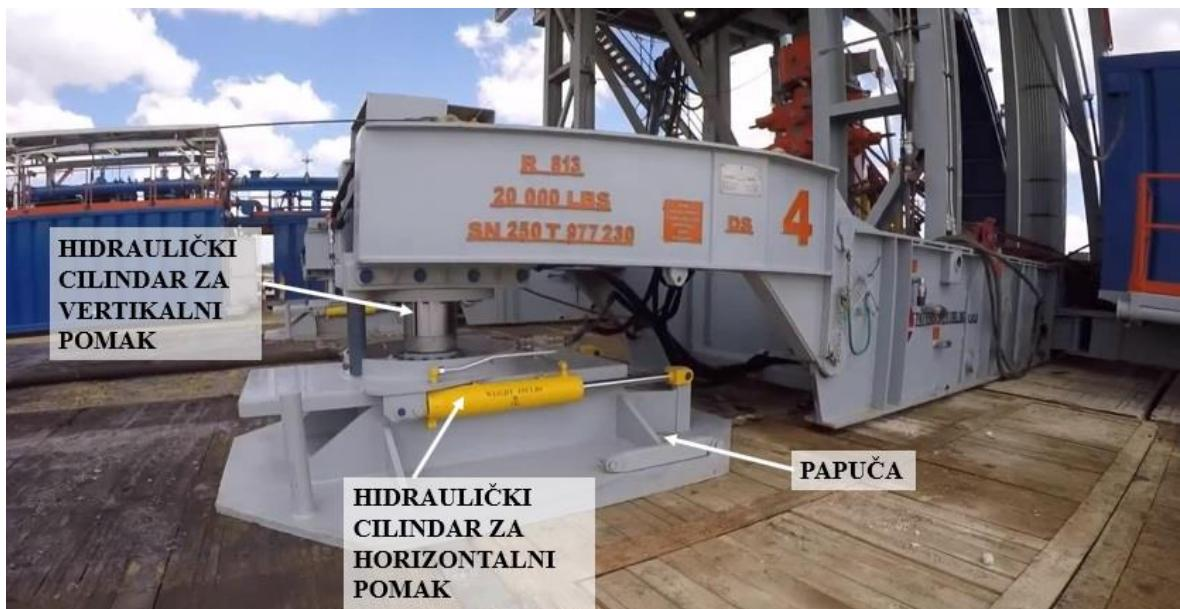
Slika 4-11. Samohodni sustav za preseljenje bušačeg postrojenja na malu udaljenost tvrtke Patterson- UTI (Patterson-UTI, 2017)
