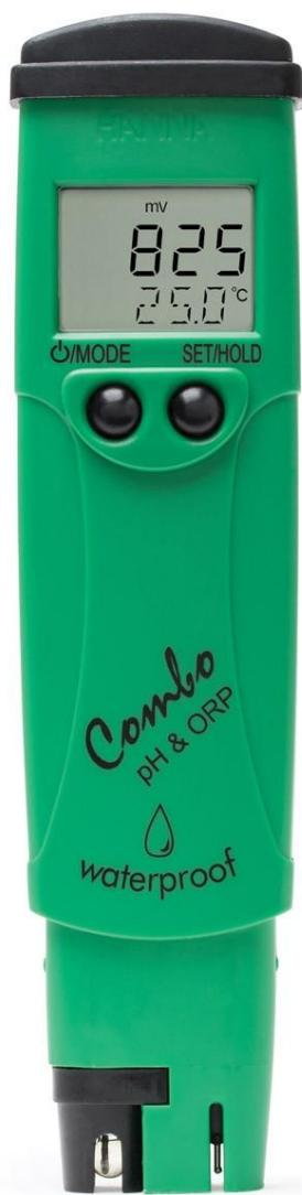
**Slika 4.4.** Uredaj za mjerjenje temperature, pH i oksidacijsko-reduksijskog potencijala vode *Hanna pH/ORP/Temperature Combo Tester* (HANNA instruments, 2018).
