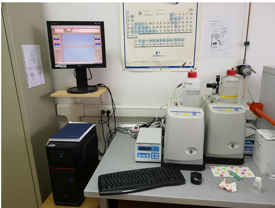
Slika 5.4. Korišteni sustav s anionskom i kationskom kolonom
