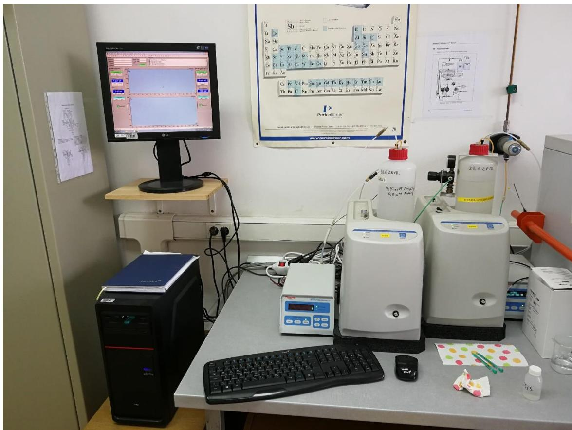
**Slika 5.4.** Korišteni sustav s anionskom i kationskom kolonom
