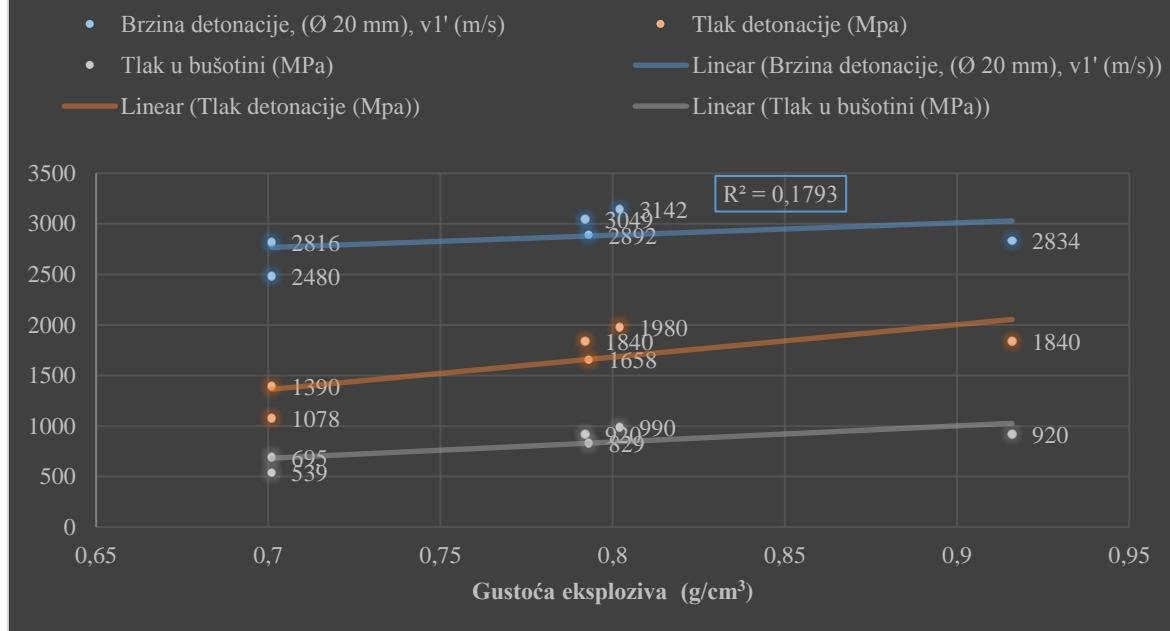
Slika 5-4 Graf ovisnosti brzine detonacije, tlaka detonacije i tlaka u bušotini o gustoći eksploziva Lambex sa dodatkom mehanički usitnjениm EPS-om
