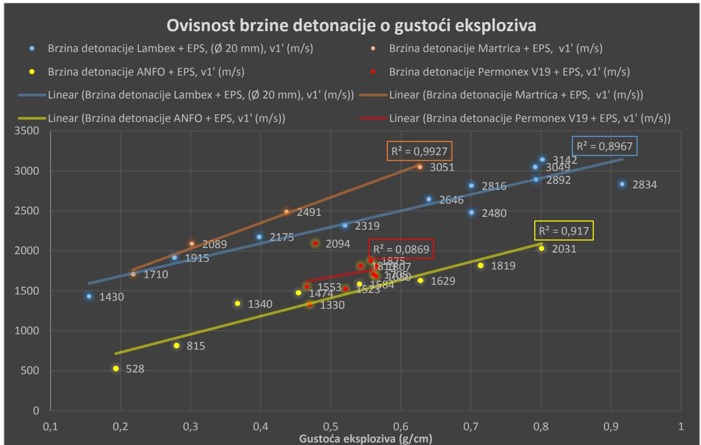
Slika 5-6 Graf ovisnosti brzina detonacije o gustoći eksploziva
