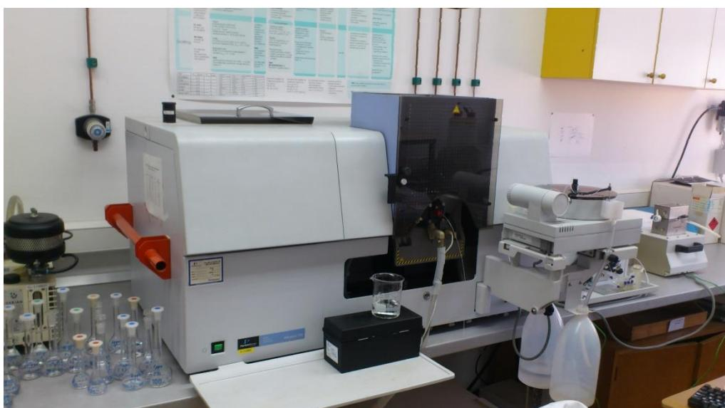
Slika 3.1 Atomski apsorpcijski spektrometar (ASS 100, foto: Škvorc, 2018)
