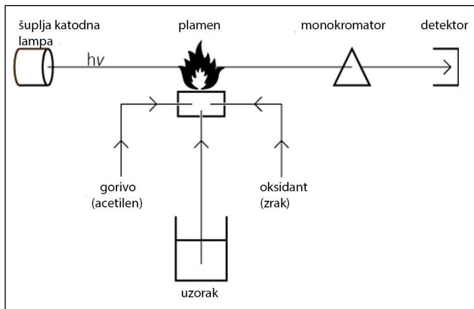
Slika 3.2 Pojednostavljena shema atomsko - apsorpcijske spektrometrije (Marić, 2014)
