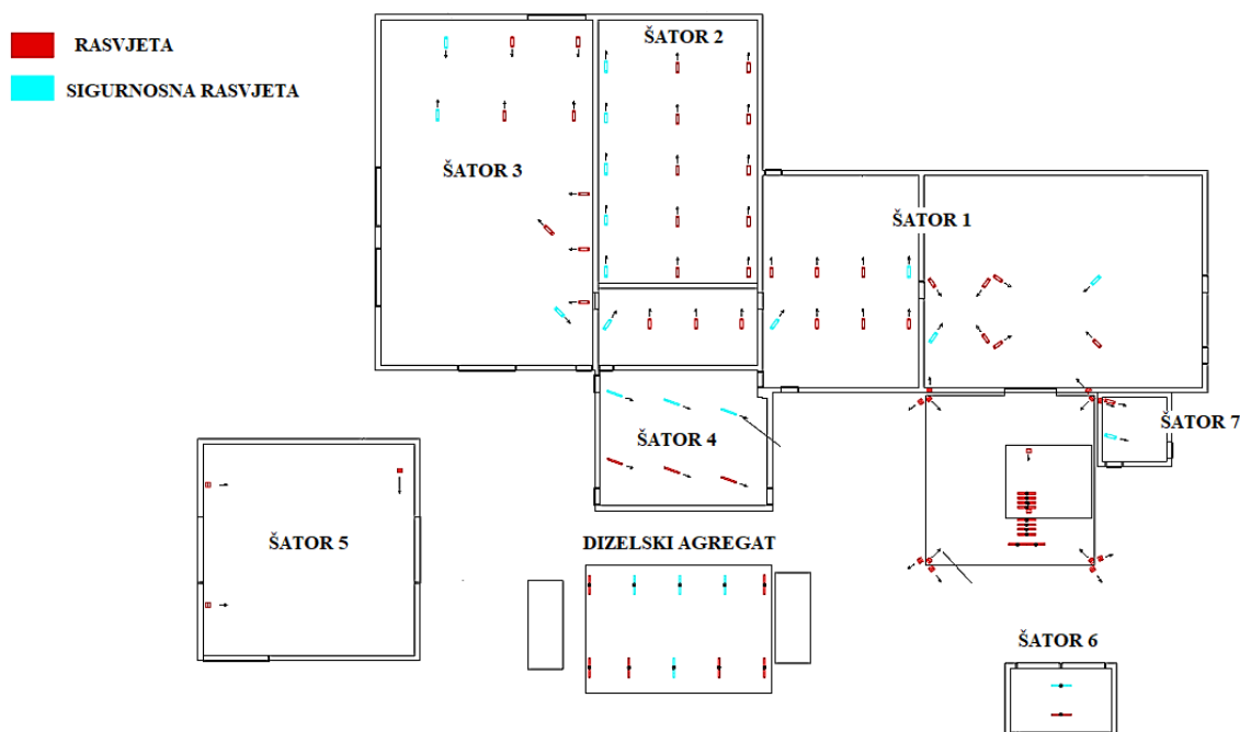
Slika 3-19. Raspored rasvjete na vinteriziranom bušačem postrojenju Emsco 605 (Crosco, 2017e)
