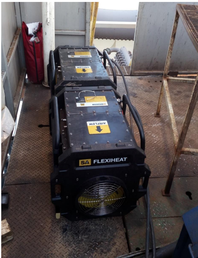
Slika 3-10. Prijenosni električni kaloriferi (Crosco, 2017b)
