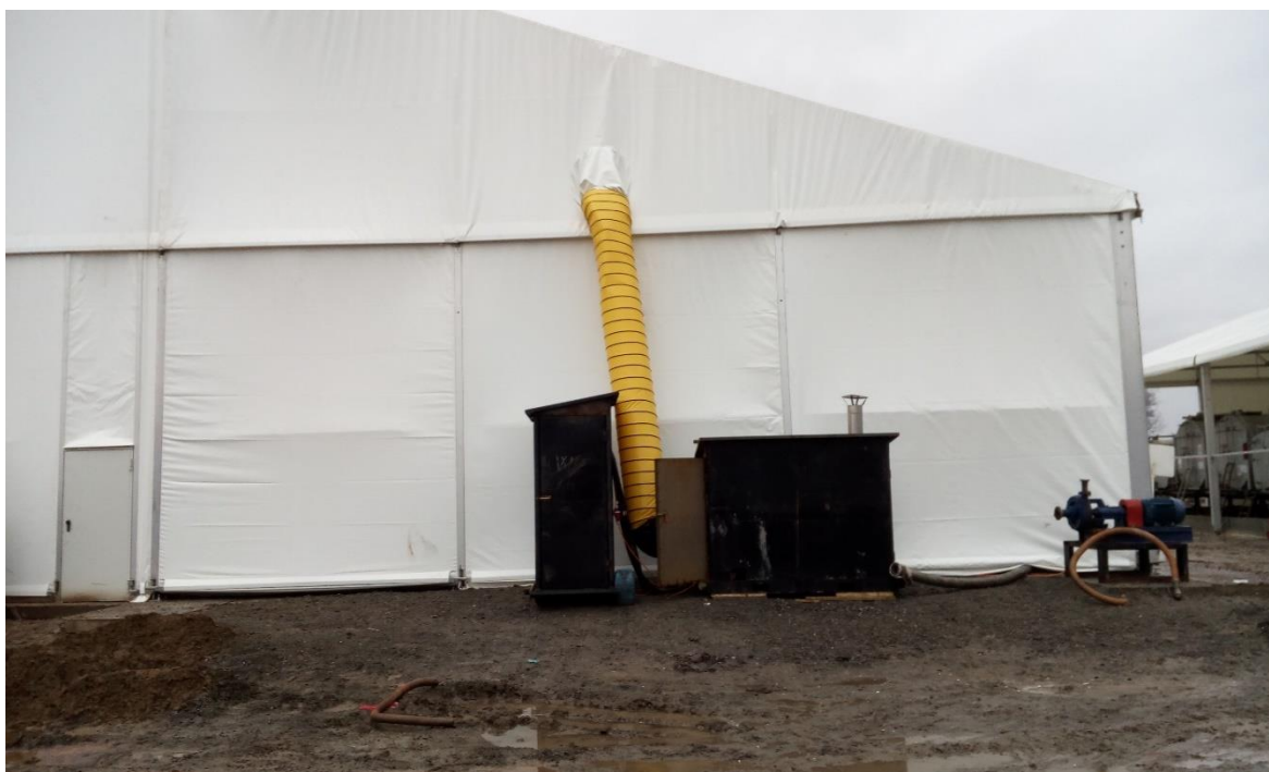
Slika 3-5. Uljni termogen (Crosco, 2017b)
