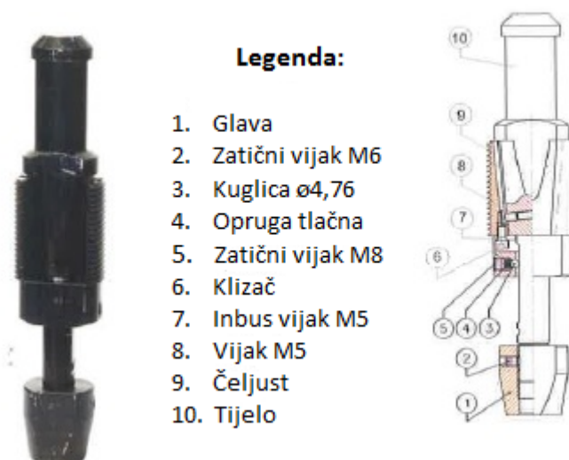
Slika 3-9. Donji zaustavljač (Katalog opreme za plinsko podizanje nafte, 2009)
