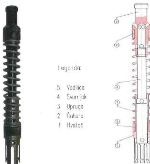
Slika 3-8. Donji amortizer udaraca klipa (Katalog opreme za plinsko podizanje nafte, 2009)
