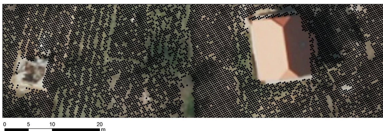
Slika 5.2 Oblak točaka (točke klasificirane kao klasa 2) dobiven laserskim skeniranjem u prosincu 2013. godine, prikazan na digitalnom ortofoto snimku.
