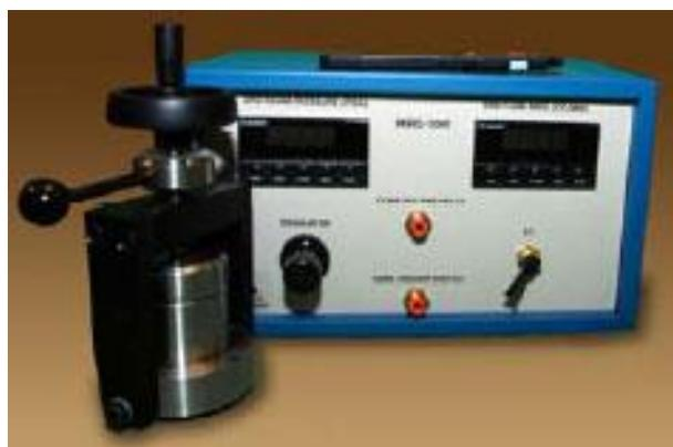
Slika 4-4. Plinski permeametar tvrtke Core Laboratories (CoreLab, 2019)
