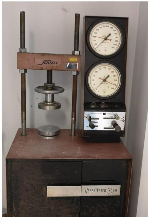
Slika 4-3. Hidraulička preša Versa Tester 30M
