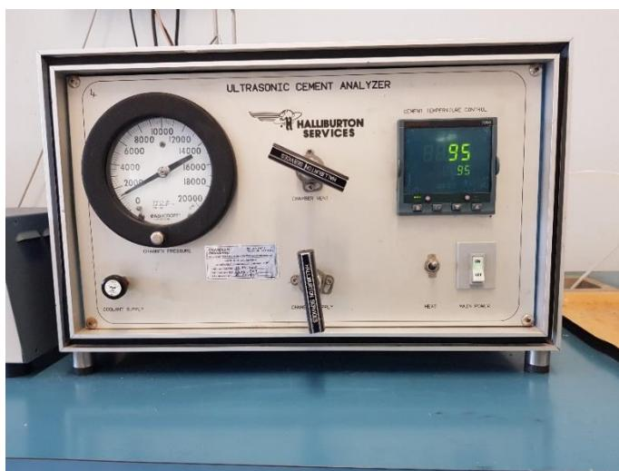
Slika 4-2. Ultrazvučni analizator (UCA)
