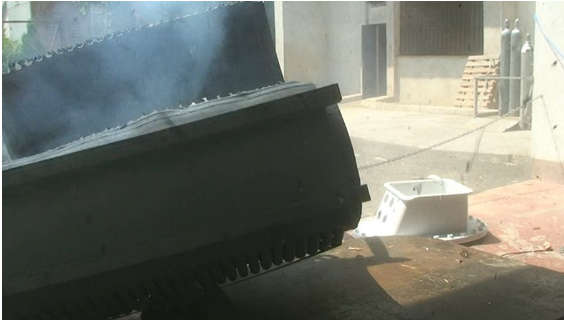
Slika 3-9 Uređaj nakon eksplozije (Ex Agencija, 2018)
