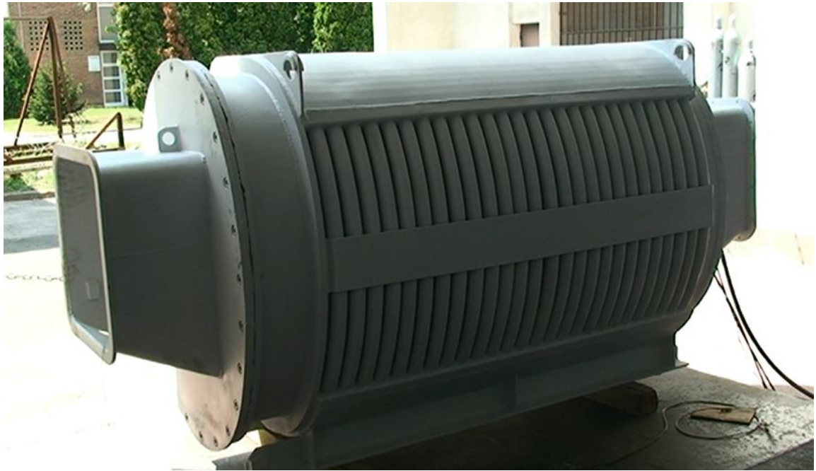
Slika 3-7 Uređaj spreman za dinamičko ispitivanje povećanog tlaka (Ex Agencija, 2018)
