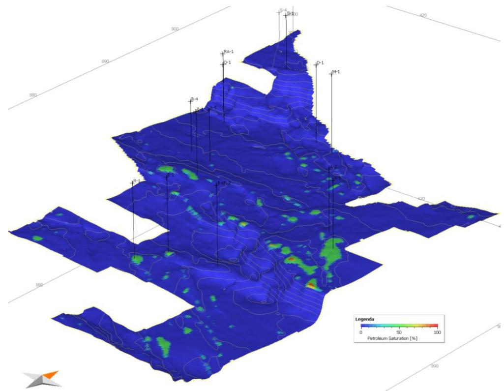
Slika 34. Prikaz zasićenja ugljikovodicima za “sloj” Alamein dolomite reservoir (3D)
