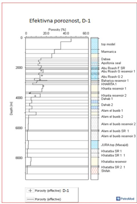
Slika 16. Kalibracija efektivne poroznosti za bušotinu D-1
