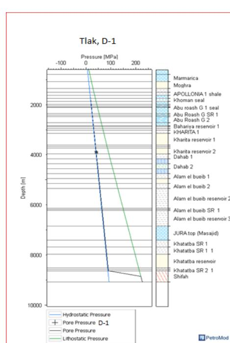
Slika 17. Kalibracija tlaka za bušotinu D-1
