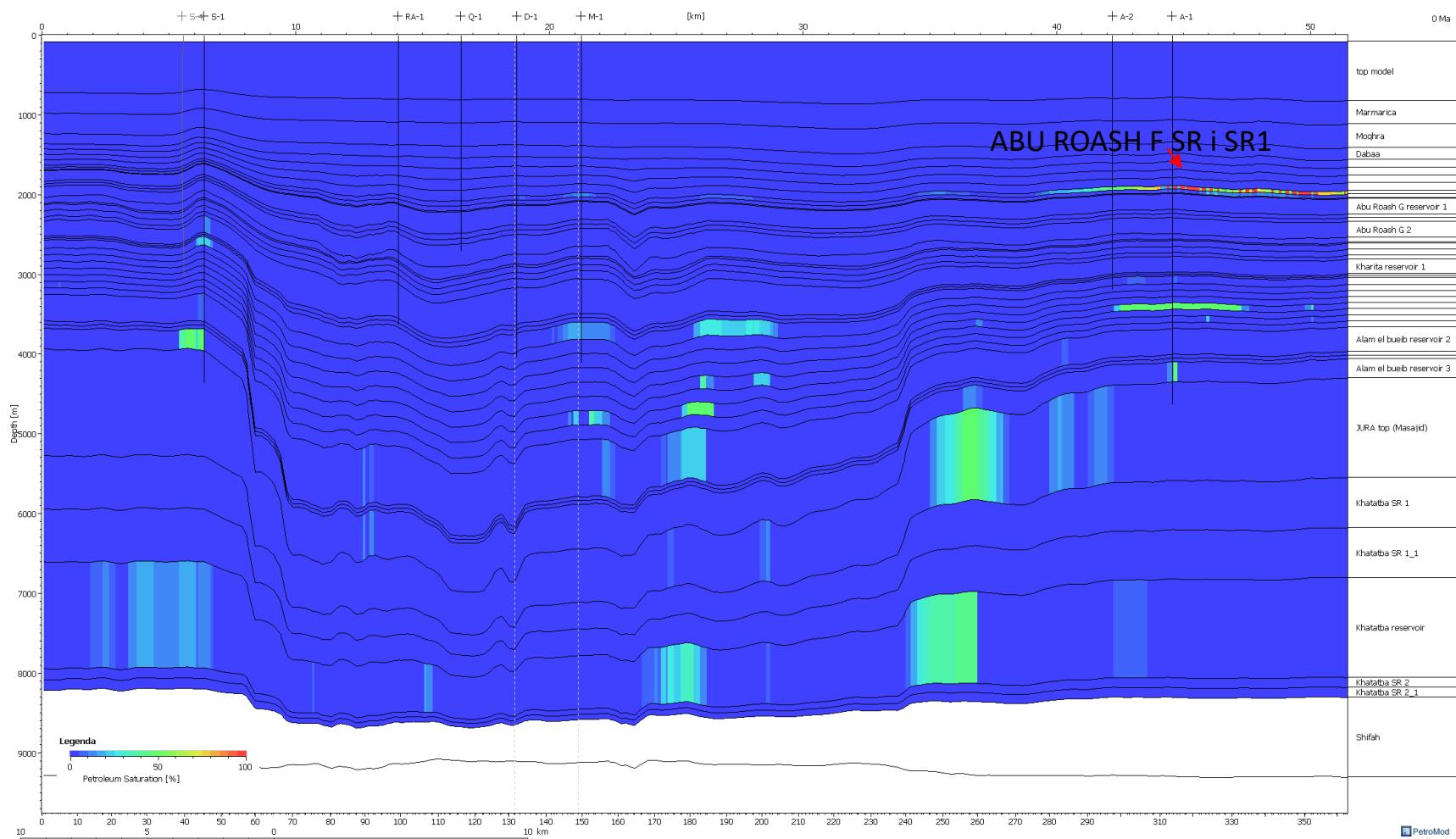
Slika 28. Karakteristični profil 2–2' s prikazom saturacije ugljikovodicima
