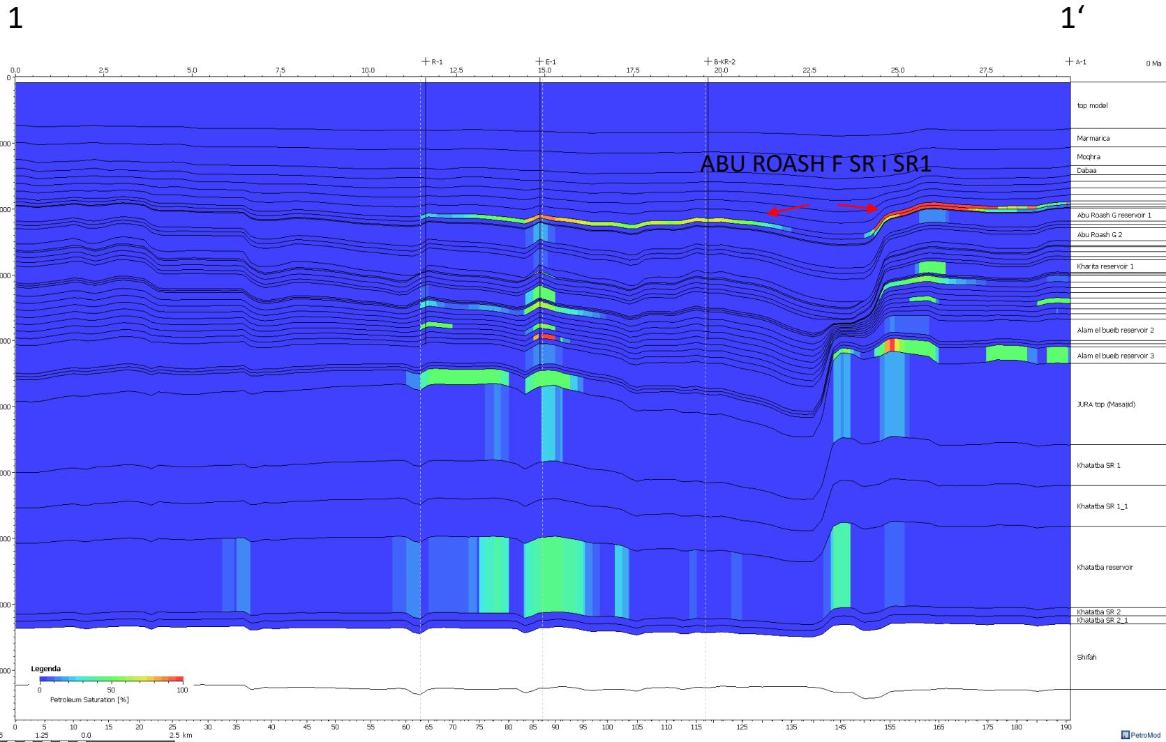
Slika 27. Karakteristični profil 1–1' s prikazom saturacije ugljikovodicima
