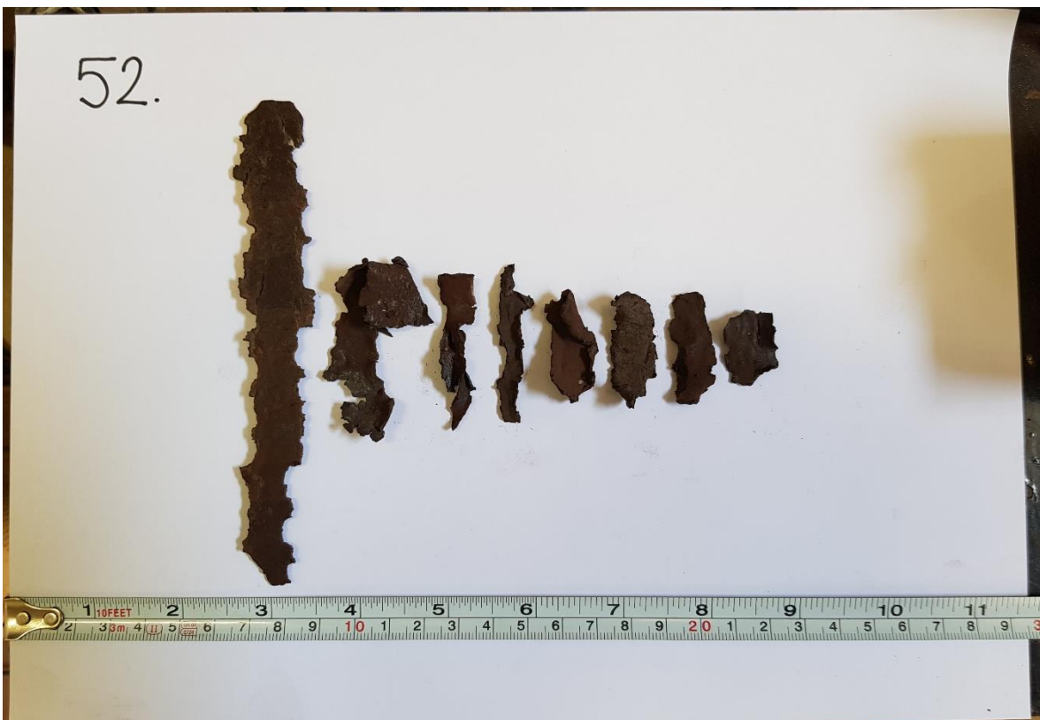
Slika 4-11. Krhotine cijevi broj 52 (63/45 \mu\text{m} , 5%)
