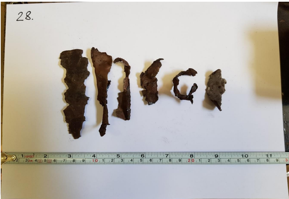
Slika 4-5. Krhotine cijevi broj 28 (-20 \mu\text{m} , 5%)
