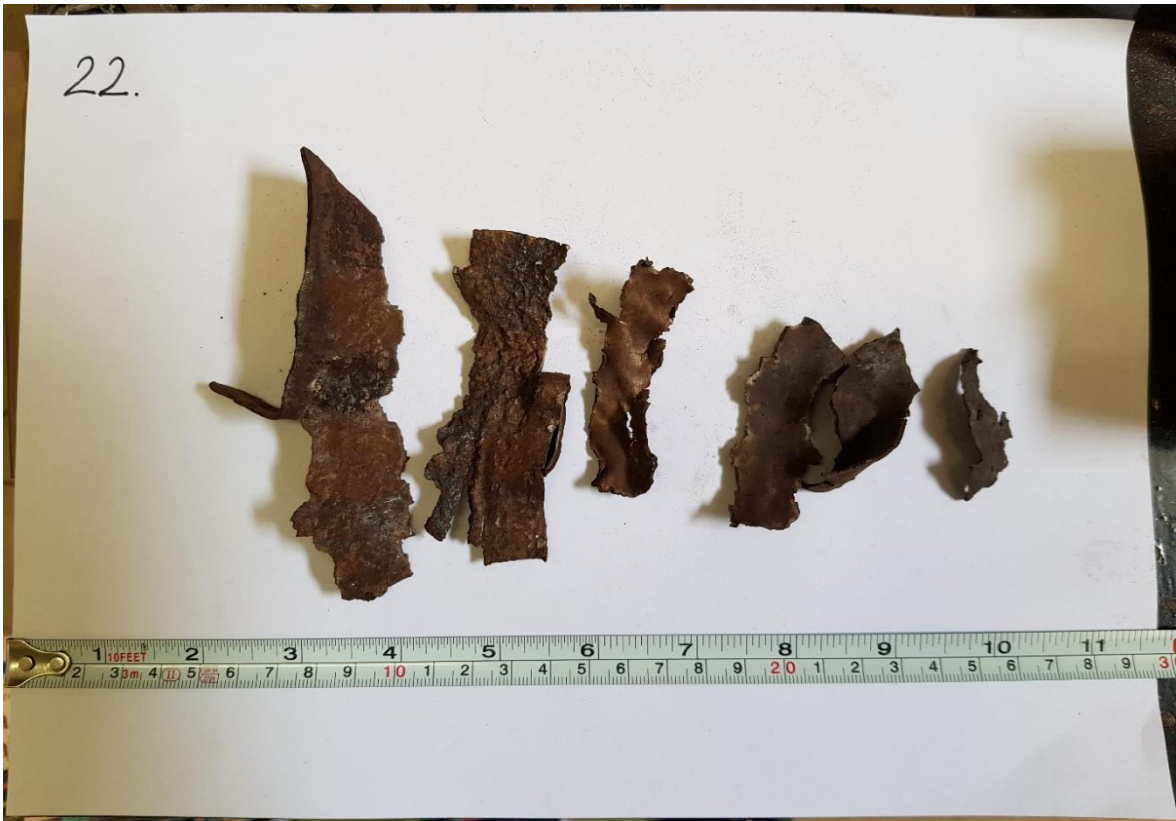
Slika 4-4. Krhotine cijevi broj 22 (-20 \mu\text{m} , 4%)
