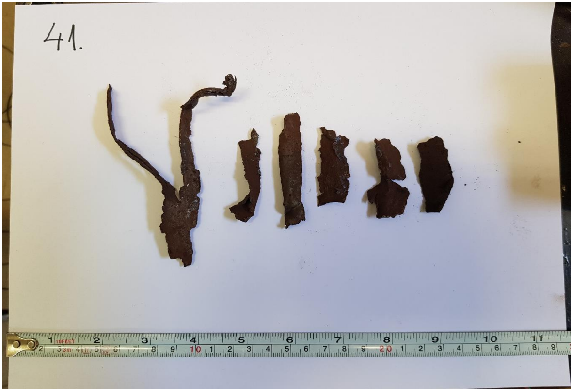
Slika 4-9. Krhotine cijevi broj 41 (63/45 \mu\text{m} , 3%)
