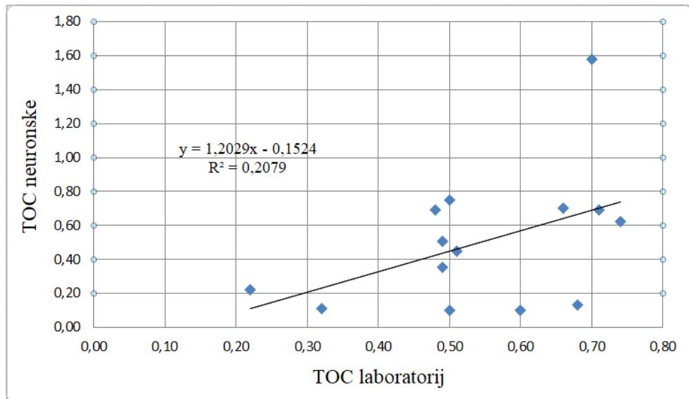
**Slika 5-5.** Odnos laboratorijski mjerenoj TOC-a i TOC-a predviđenog neuronskom mrežom u bušotini A-1.
