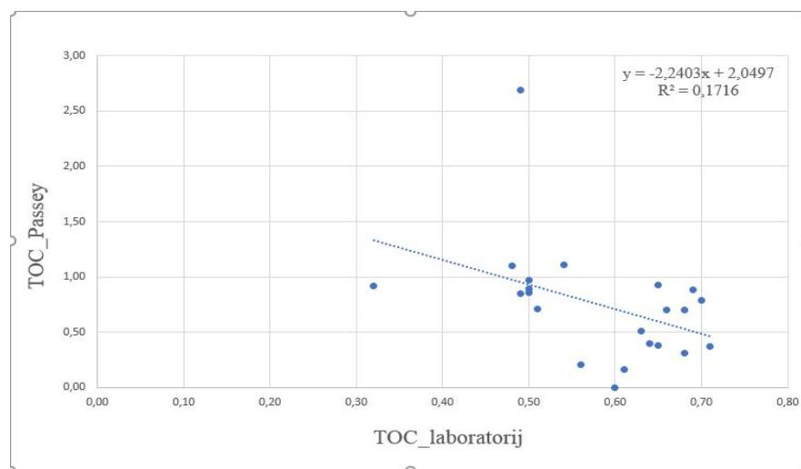
**Slika 5-2.** Odnos laboratorijski mjerenoj TOC-a i TOC-a izračunatog Passeyevom metodom.
