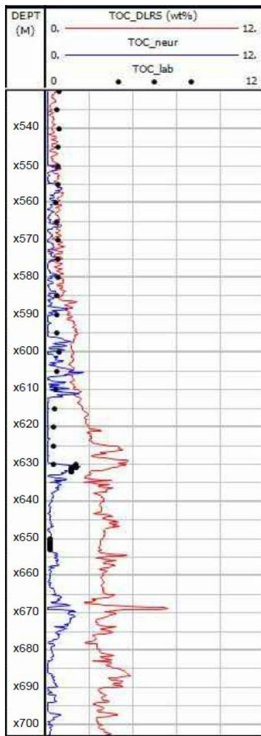
**Slika 5-6** Usporedba rezultata neuronske mreže (TOC\_neur), Passeyeve metode (TOC\_DLRS) i laboratorijski mjerenoj TOC-a (TOC\_lab) u bušotini A-2.
