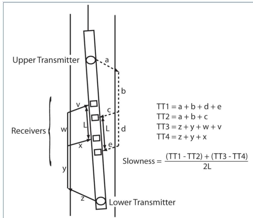
**Slika 4-9.** Skica sonde za zvučnu karotažu s dva odašiljača i četiri prijamnika (preuzeto iz Close et al., 2009).
