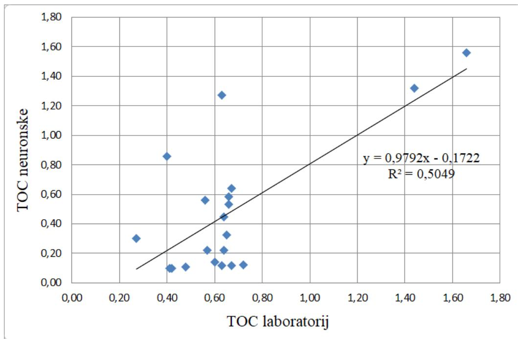
**Slika 5-7.** Odnos laboratorijski mjerенog TOC-a i TOC-a predviđenog neuronskom mrežom u bušotini A-2.
