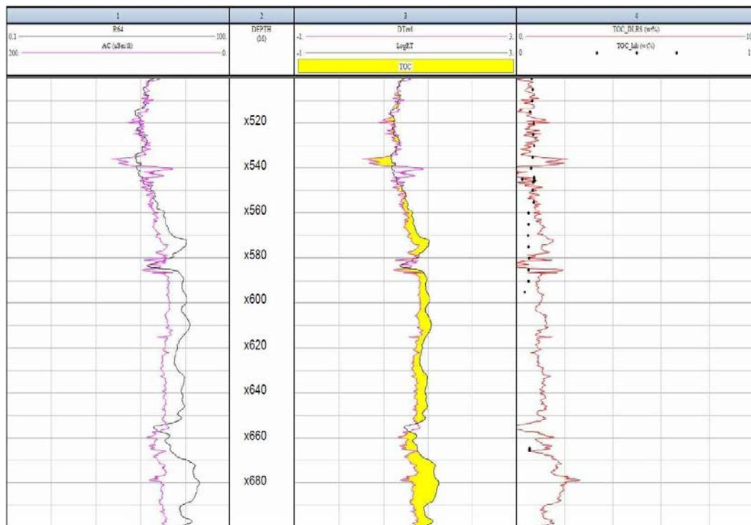
**Slika 5-1.** Karotažni dijagrami bušotine A-1 analizirani Passeyevom metodom s usporedbom krivulje izračunatih TOC vrijednosti (TOC\_DLRS) i laboratorijskih mjerjenja ( TOC\_lab)
