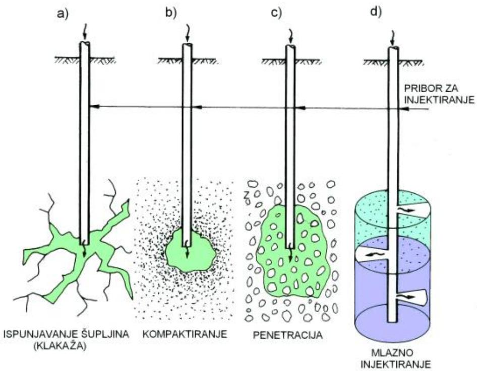
Slika 2-10 Shematski prikaz vrsta injektiranja (Welshetal., 1986)
