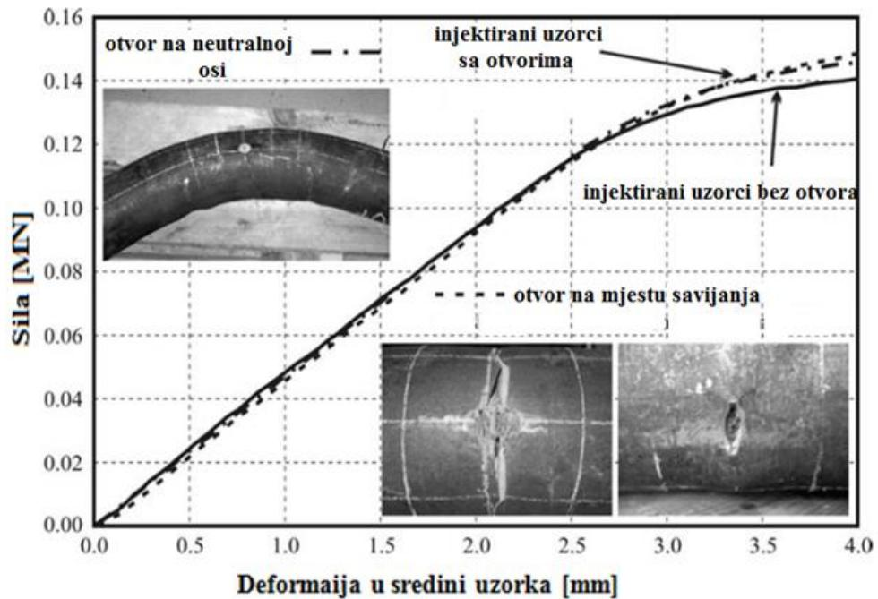
Slika 2-8 Rezultati ispitivanja na cijevi bez otvora te na cijevi sa otvorom (Volkmann & Schubert, 2008)
