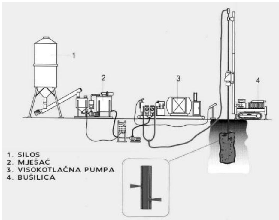
Slika 2-13 Shematski prikaz postrojenja jednofluidnog sustava mlaznog (Čorko, 1997.)
