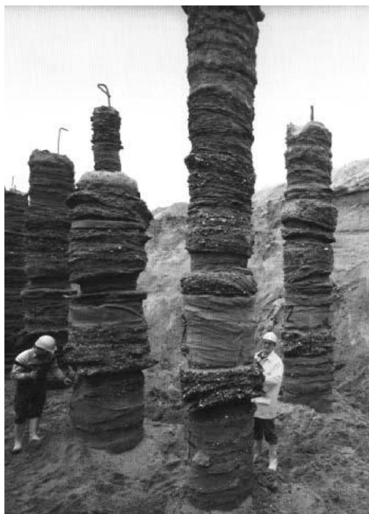
Slika 2-12 Cilindrična tijela u slojevitom tlu (Dimitrios Kolymbas, 2008)
