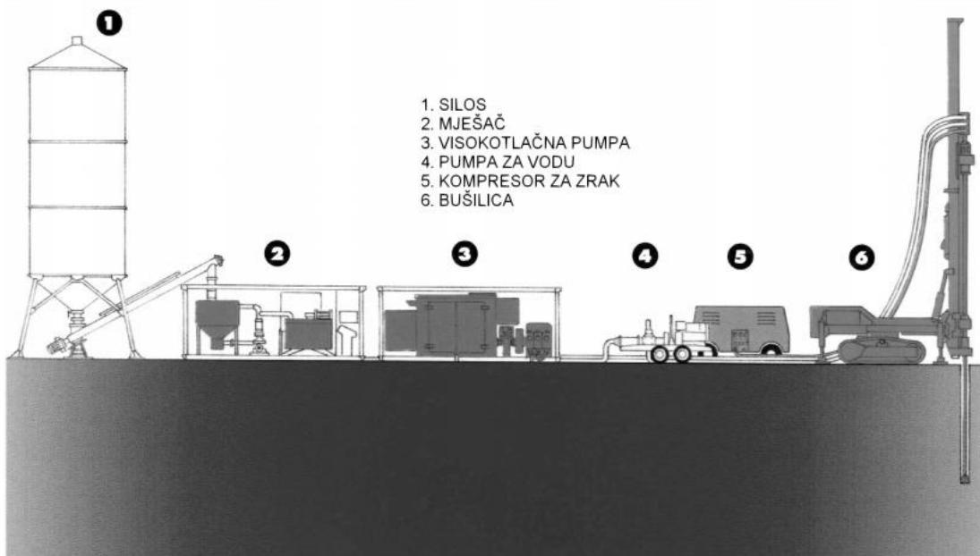
Slika 2-19 Shematski prikaz postrojenja trofluidnog sustava mlaznog injektiranja (Čorko, 1997.)
