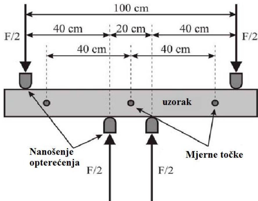
Slika 2-7 Uređaj za ispitivanje deformacije cijevi (Volkmann & Schubert, 2008)
