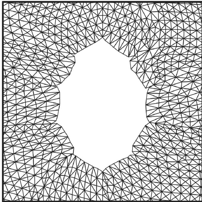
Slika 2-6 Deformacije nastale metodom prethodnog bušenja (Volkmann & Schubert, 2006)
