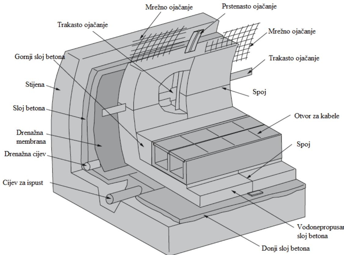
Slika 2-30 Drenažna podzemne željeznice (Kolymbas, 2008.)
