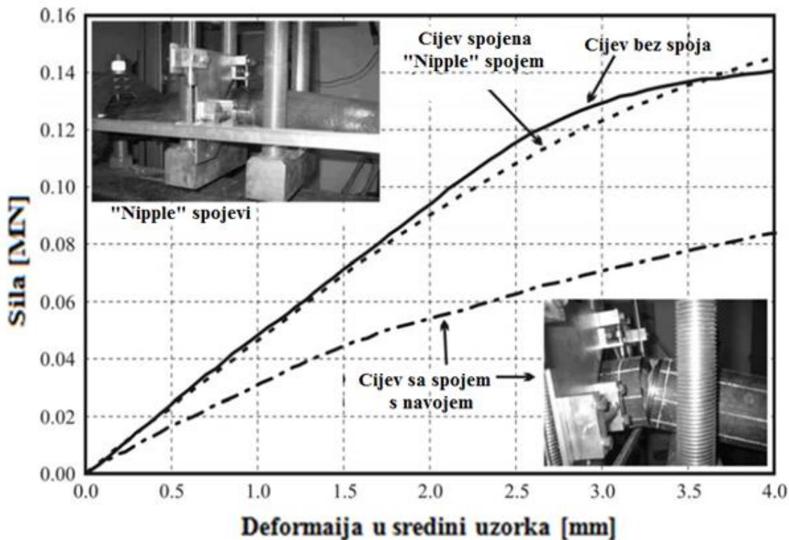
Slika 2-9 Rezultati ispitivanja na cijevima s različitim spojevima (Volkmann & Schubert, 2008)
