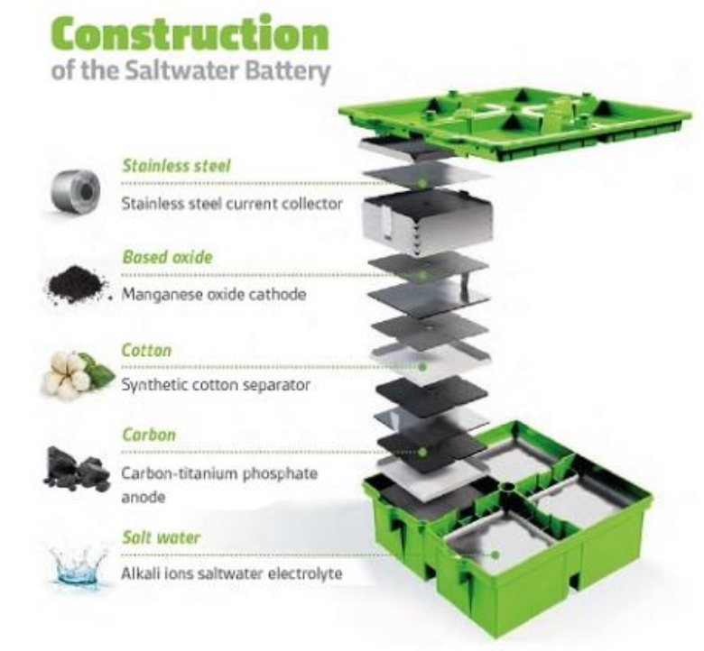
Slika 4-12. Konstrukcija natrij-ionske baterije (Izvor: GreenRock)
