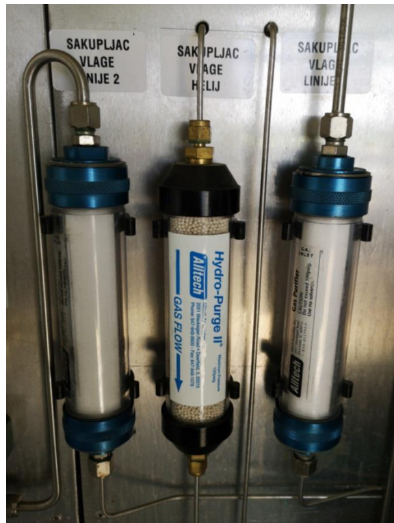
Slika 5-4. Sakupljač vlage iz uzorkovanog plina i plina nosioca (helij)
