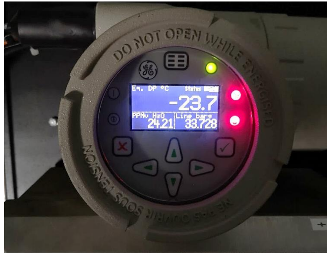
Slika 5-10. AURORA, analizator za mjerenje rosišta vode u plinu
