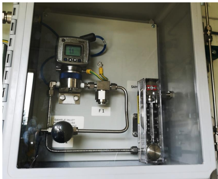
Slika 5-13. Oxy.IQ analizator za mjerenje udjela kisika u plinu
