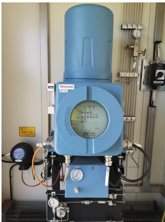
Slika 5-8. Kromatograf Danalyzer 700XA
