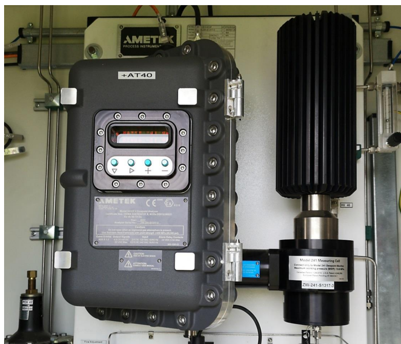
Slika 5-11. Ametek, analizator za mjerenje rosišta ugljikovodika
