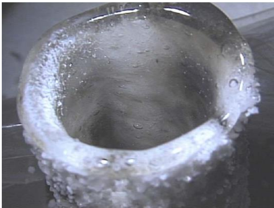
Slika 4-2. Nepropusna stijenka Berea pješčenjaka nakon primjene kemijskog kisik-jod lasera (Batarseh et al., 2003)
