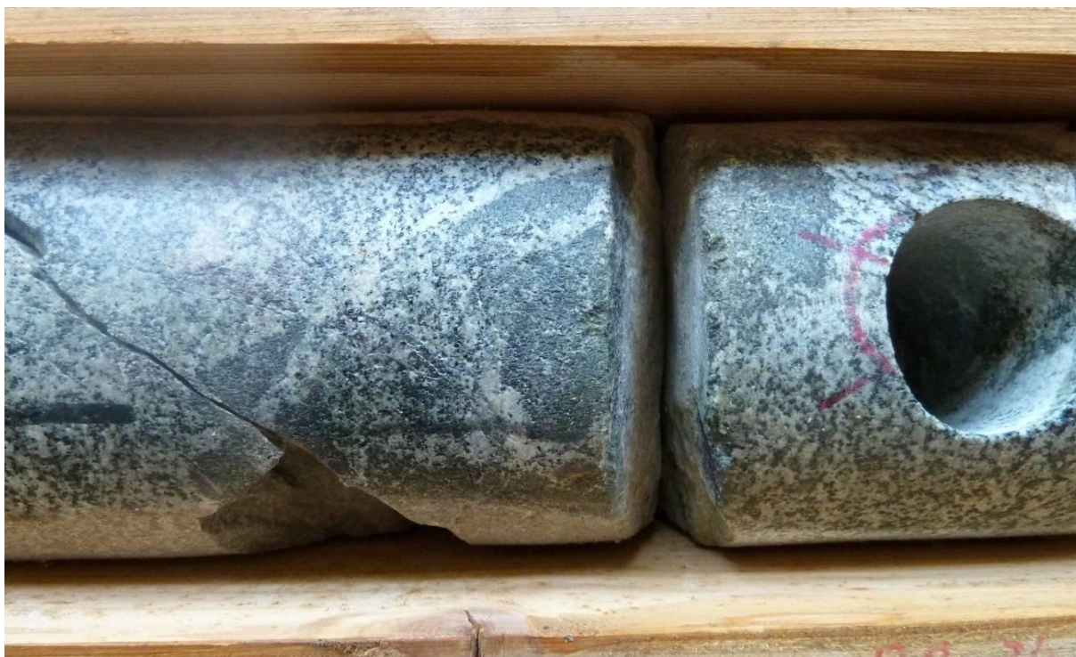
Slika 7.33 Granodiorit s uglatim i nepravilnim enklavama hornblenda dijabaza. Na granici s enklavama prisutan je leukokratni halo unutar granodiorita. Obod-34, J-17, interval 2394 – 2403 m.
