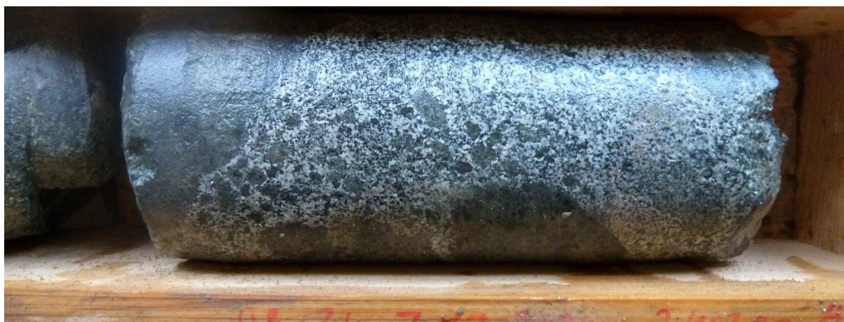
Slika 7.34 Granodiorit sa zaobljenim enklavama hornblenda dijabaza, koje imaju različite dimenzije, (od 1 cm do preko 10 cm). Obod-34, J-17, interval 2394 – 2403 m.
