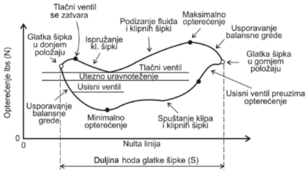
Slika 2-7. Dinamogram opterećenja klipnih šipki (Zelić i Čikeš, 2006)
