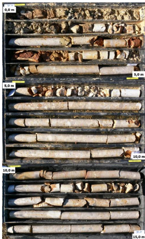
Slika 5.14. Fotografija jezgre iz istražne bušotine izvedene u Obrovcu
