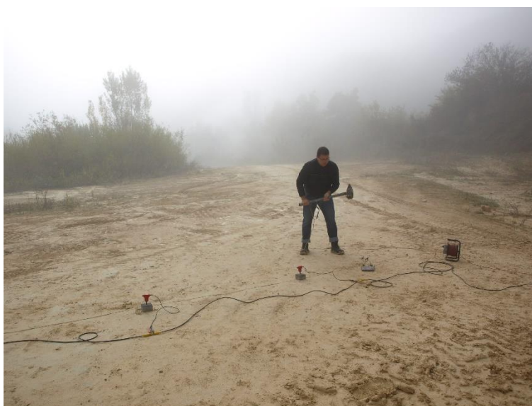
Slika 6.16. Provođenje terenskih geofizičkih ispitivanja na 1. etaži kamenoloma Marčan, priprema za generiranje seizmičkih valova čekićem mase 10 kg
