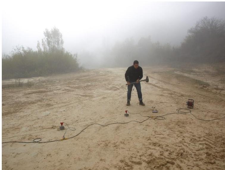
**Slika 6.16.** Provodenje terenskih geofizičkih ispitivanja na 1. etaži kamenoloma Marčan, priprema za generiranje seizmičkih valova čekićem mase 10 kg
