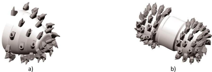
**Slika 4.26.** Tipovi rotirajuće glave: a) longitudinalna; b) transverzalna (Sandvik Tamrock, 1999)
