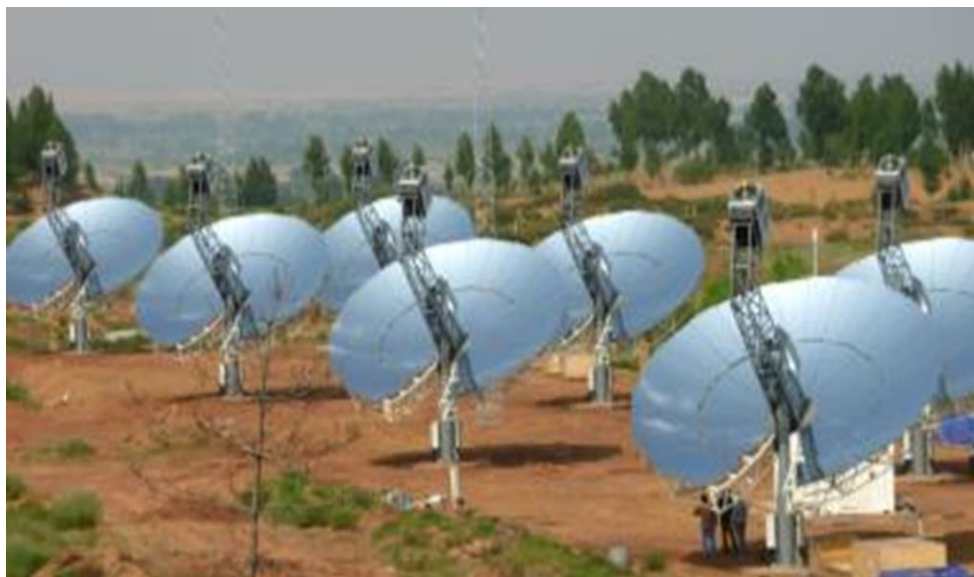
Slika 3-5. Stirling stroj snage 10 kW, Ordos, Kina (Baumueller, 2012)
