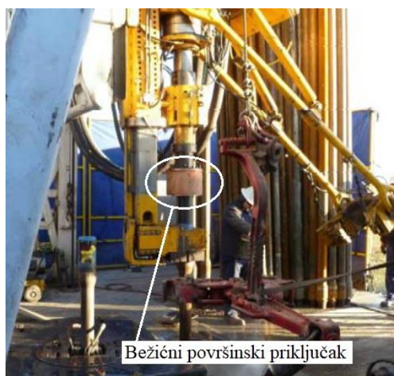
Slika 6-10. Bežični površinski sustav WDP telemetrijskog sustava druge generacije (Macpherson et al., 2019)
