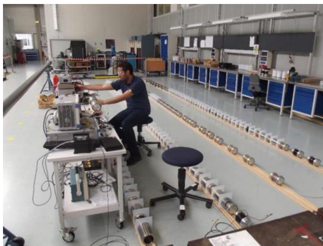
Slika 6-13. Laboratorijsko ispitivanje s mikro-prijenosnicima povezanim u petlju (Macpherson et al., 2019)
