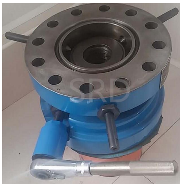
Slika 4-3. Rotator tubinga pokretan ručno ( www.alibaba.com , 31.3.2020.)
