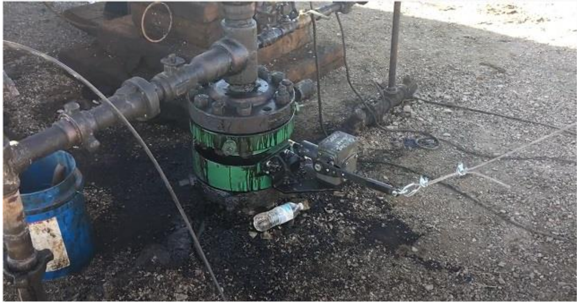
Slika 4-5. Mehanički rotator tubinga (www.youtube.com, 10.12.2019.)
