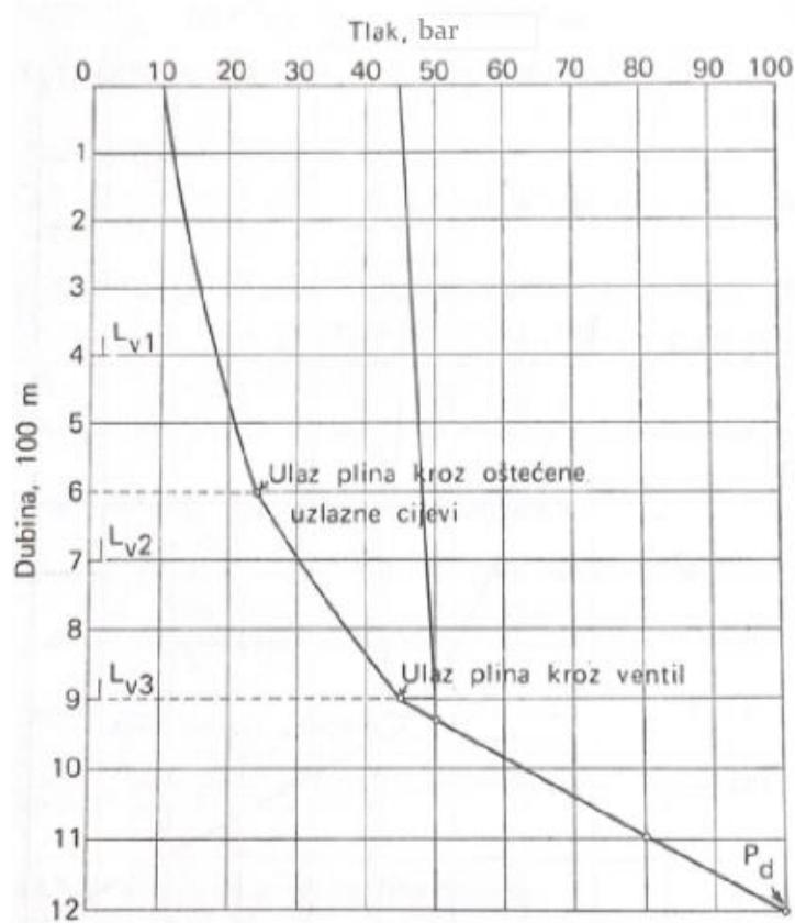
**Slika 2-2.** Krivulja gradijenta tlaka u neprekidno liftiranoj bušotini (Zelić, 1977.)
