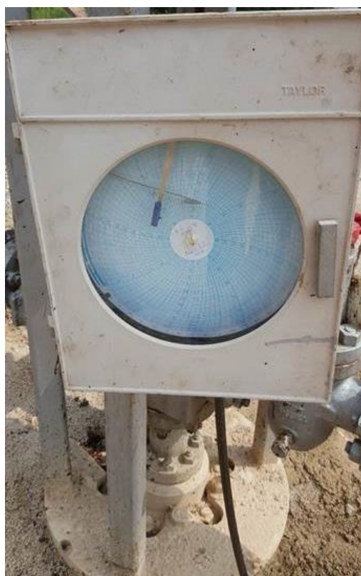
Slika 2-9. Registrirajući manometar na bušotini X u Hrvatskoj (Brkić, 2018.)
