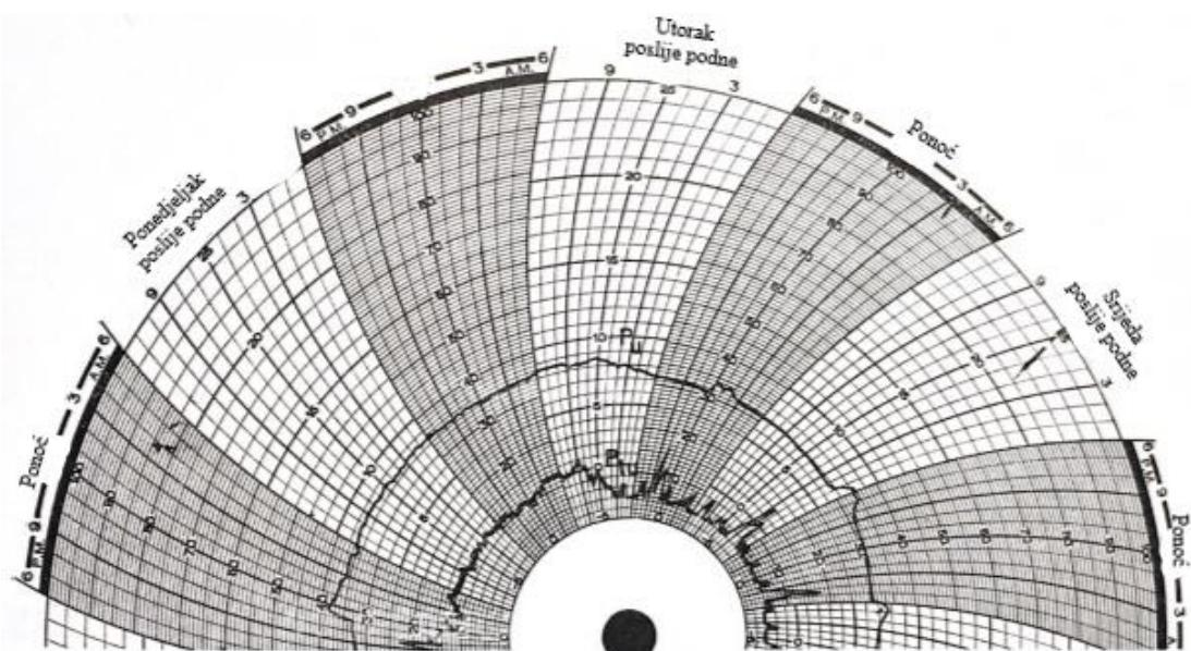
**Slika 2-14.** Dijagram registriranih tlakova na tubingu ( $P_{tu}$ ) i prestenastom prostoru ( $P_u$ ) pri neustaljenom protoku kod neprekidnog podizanja kapljevine (Zelić, 1977.)
