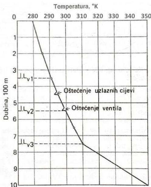
**Slika 2-4.** Krivulja gradijenta temperature u buštoni opremljenoj plinskim liftom (Zelić, 1977.)
