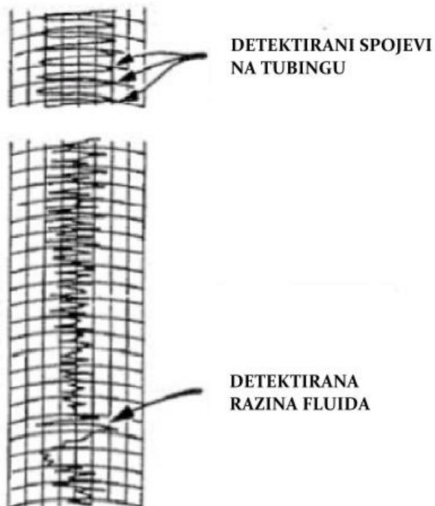
**Slika 2-7.** Grafički prikaz mjerena dobivenih zvučnom metodom (Brown, 1980.)
