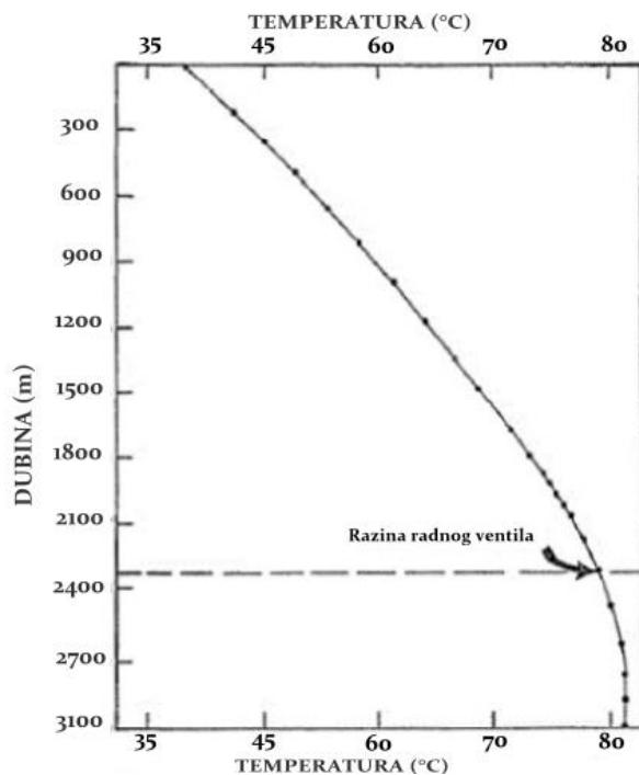
**Slika 2-5.** Krivulja gradijenta temperature u buštoni s visokom proizvodnošću opremljenom plinskim liftom (Brown, 1980.)
