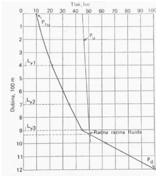
**Slika 2-1.** Krivulja gradijenta tlaka u neprekidno liftiranoj bušotini (Zelić, 1977.).
