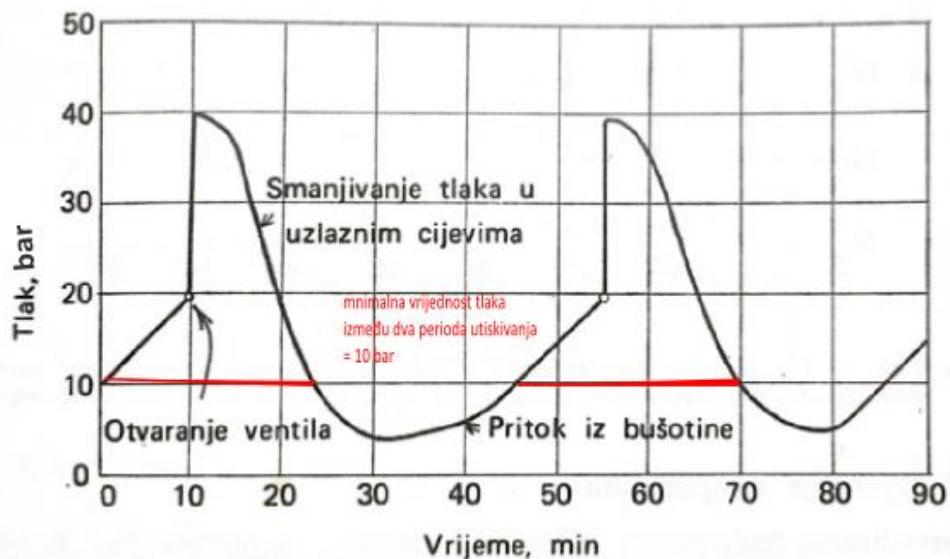
**Slika 2-3.** Dijagram ovisnosti tlaka o vremenu u povremenoj liftiranoj bušotini (Zelić, 1977.)
