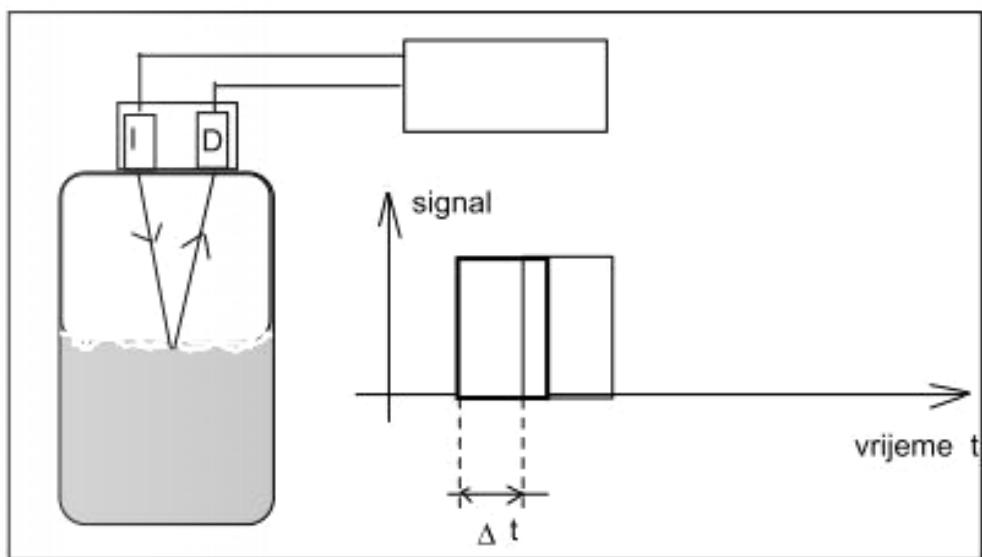
**Slika 2-6.** Shematski prikaz mjerena zvučnom metodom (Kurtenjak, 2007.)
