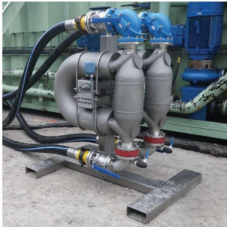
**Slika 2-15.** Coriolisov mjerač protoka (Jacobs, 2015)
