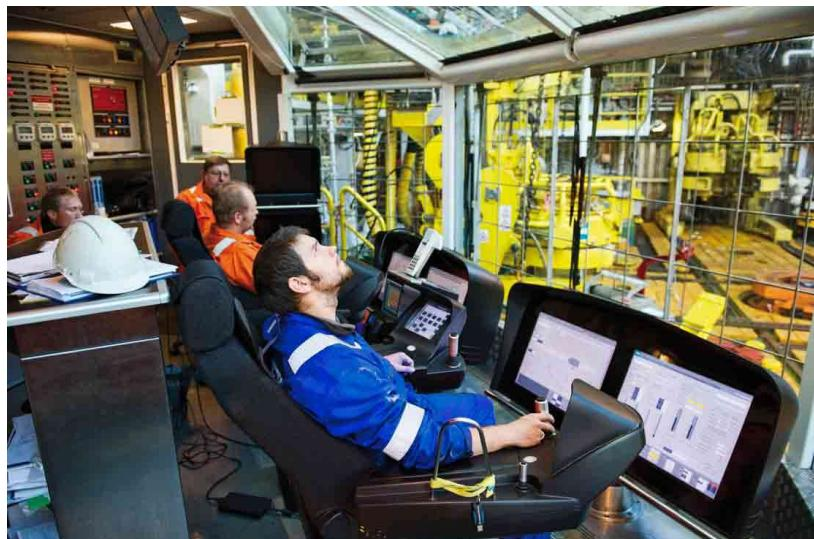
**Slika 3-1.** Moderna bušača soba s digitalnim prikazom parametara bušenja (Schlumberger, 2020)
