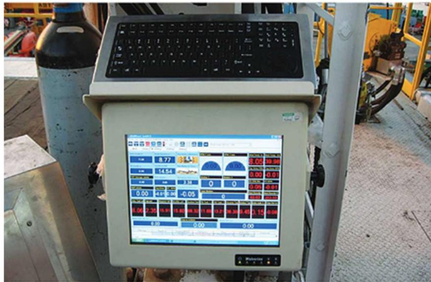
**Slika 2-13.** Električni drilogram (Weatherford, 2015 a)
