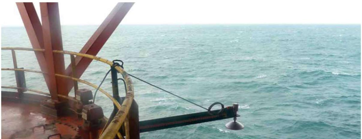
**Slika 4-1.** Uporaba radarskog mjernog pretvornika razine za određivanje visine vode
