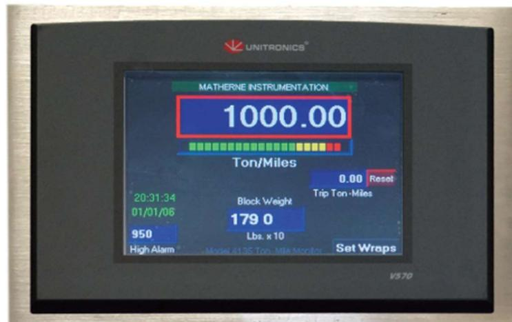
**Slika 2-21.** Mjerač rada bušaćeg užeta (Matherne Instrumentation, 2017 a)
