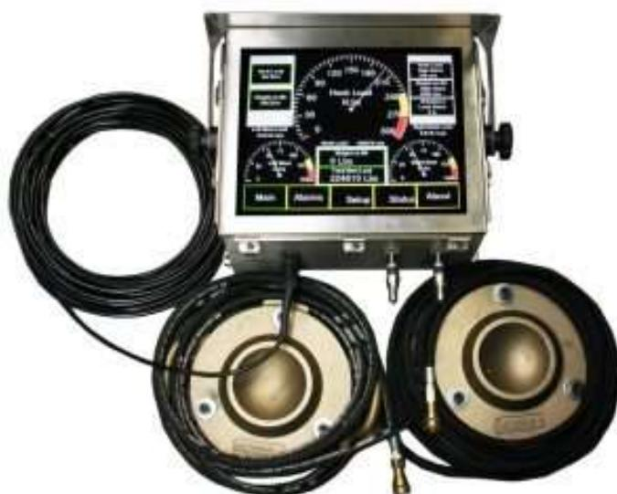
**Slika 2-5.** Električni indikator težine (Matherne Instrumentation, 2020 f)
