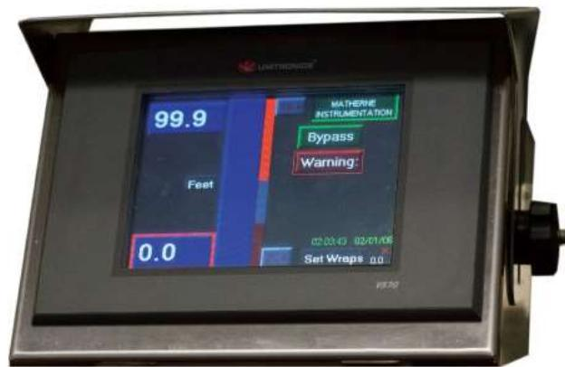
**Slika 2-23.** Elektronički uređaj za sprječavanje sudara pomičnog i nepomičnog koloturja
