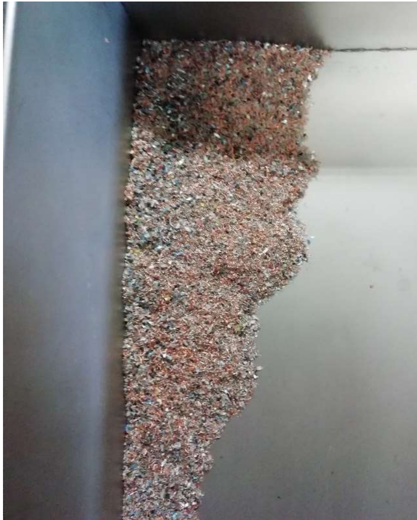
Slika 6-12 Separirani uzorak u posudi za vodič nakon višestrukog propuštanja kroz elektrostatički separator
