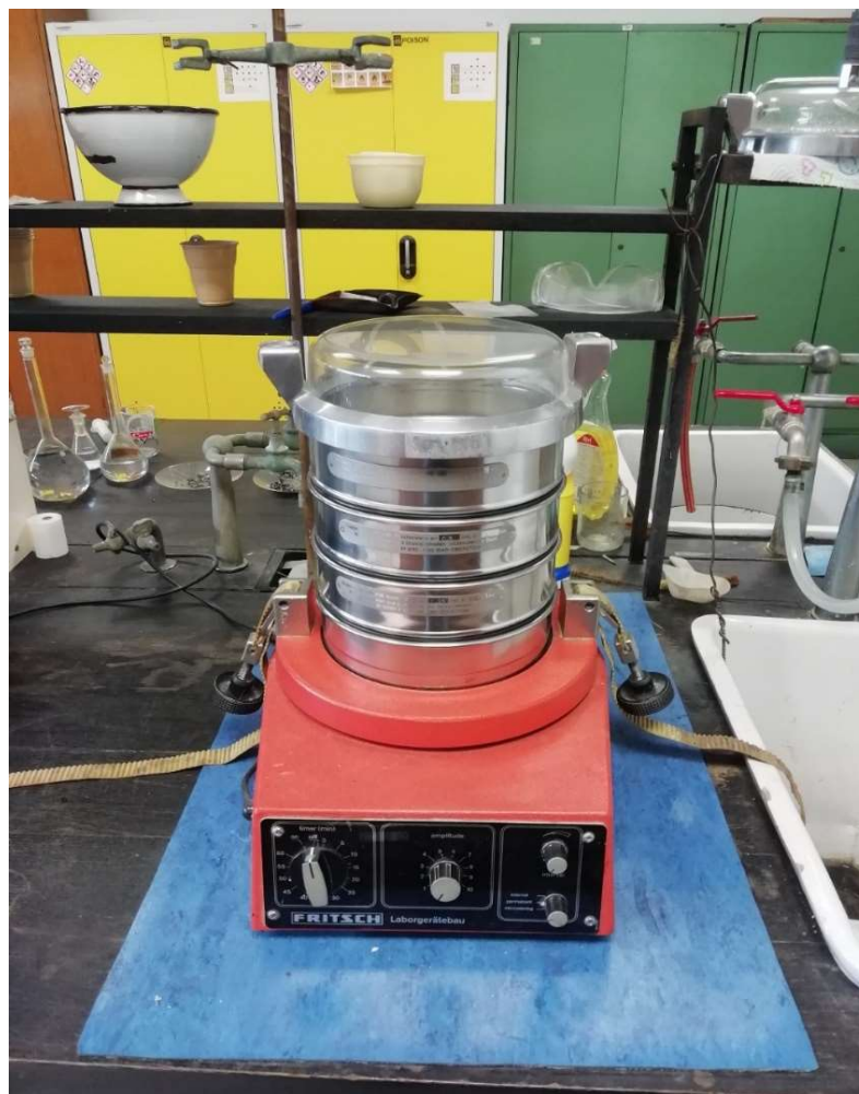
Slika 6-5 Laboratorijsko elektromagnetsko sito FRITSCH Analysette 3 (FRITSCH, 2020)
