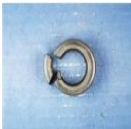
Slika 3 - 2. Lom sjedišta usisnog ventila (Maher, 2016)
