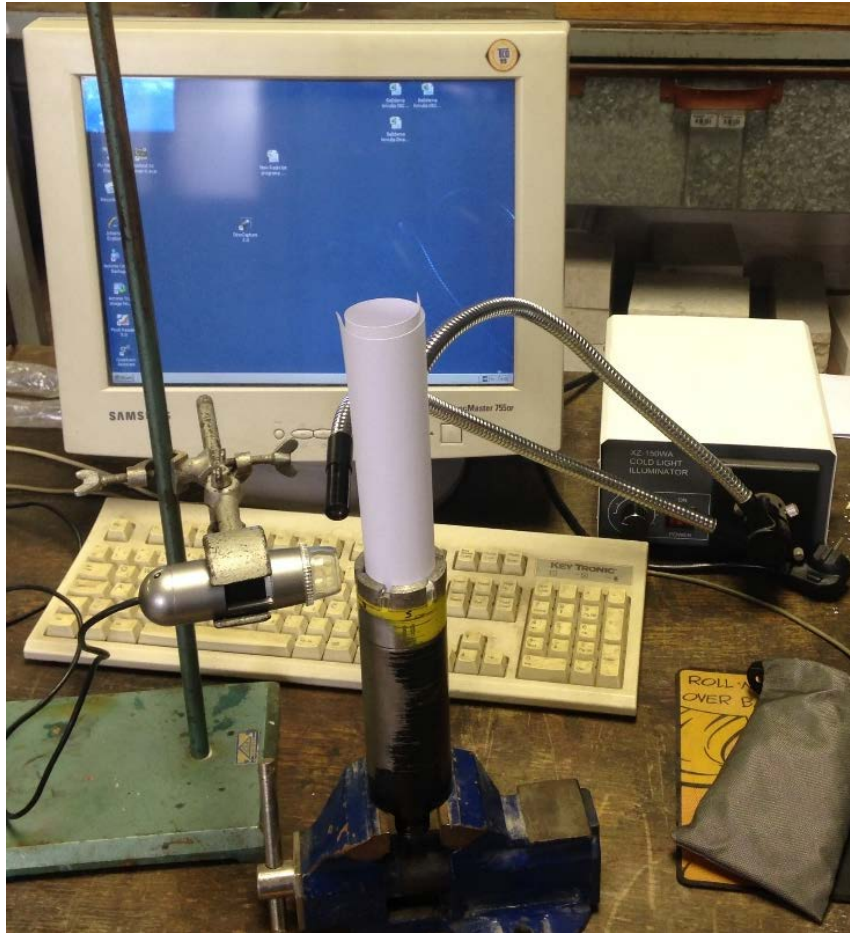
Slika 3.7. Mjerenje dubine rezanja i broja eksponiranih dijamantnih zrna reznih segmenata bušaće krune
