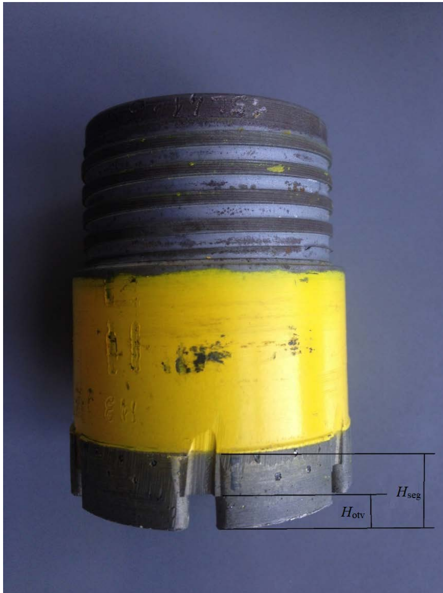
Slika 3.5. Bušaća kruna Atlas Copco
