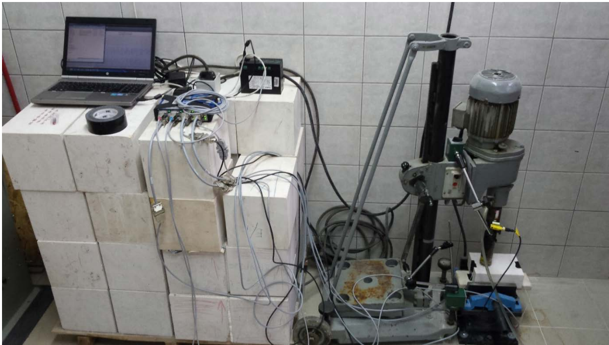
Slika 3.15. Mjerni sustav za mjerenje snage te mjerni sustav s mjernim pretvornikom sile i okretnog momenta spojeni na laboratorijsku bušilicu
