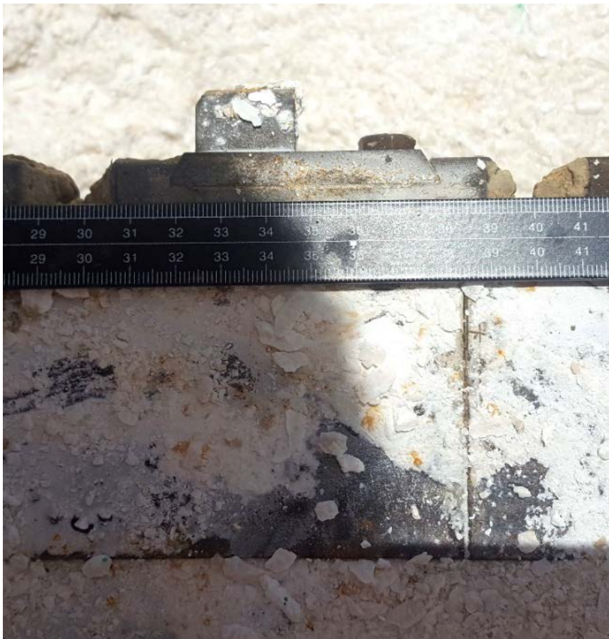
Slika 3.63. Mjerenje duljine članka reznog lanca lančane sjekačice
