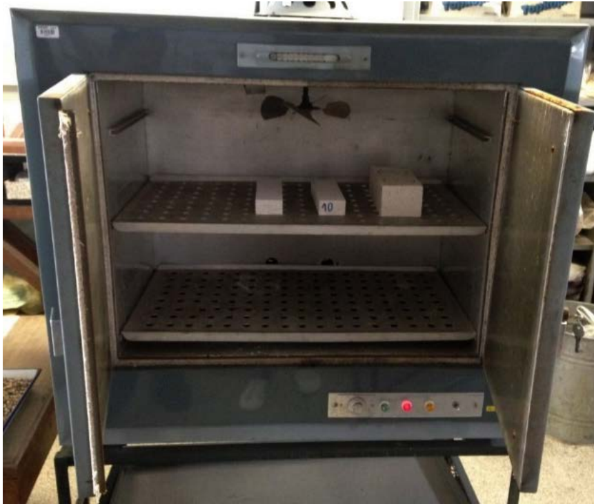
Slika 3.45. Sušionik sa stijenskim uzorcima
