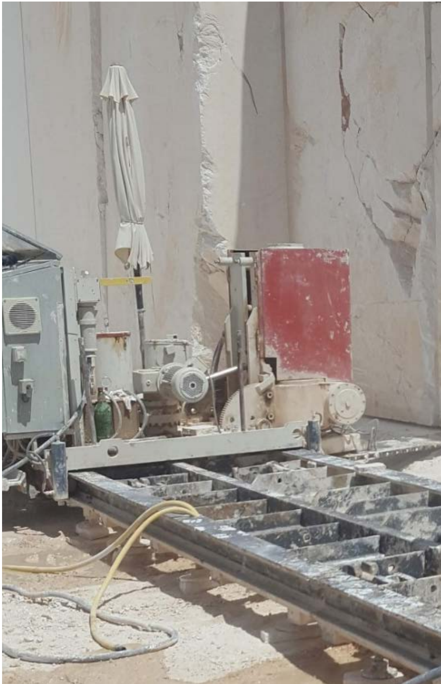
Slika 3.52. Lančana sjekačica Pellegrini Ch-60
