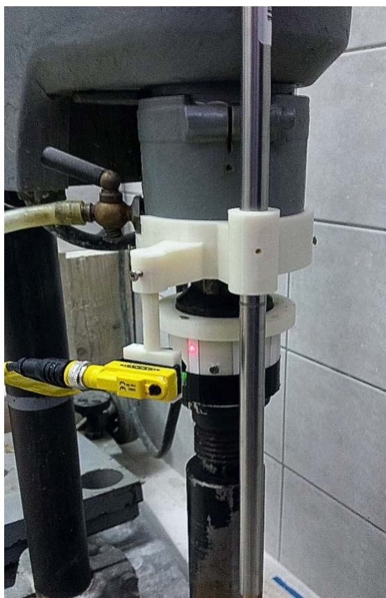
Slika 3.40. Nosač LVDT-a i osjetila za mjerenje broja okretaja postavljen na kućište bušilice
