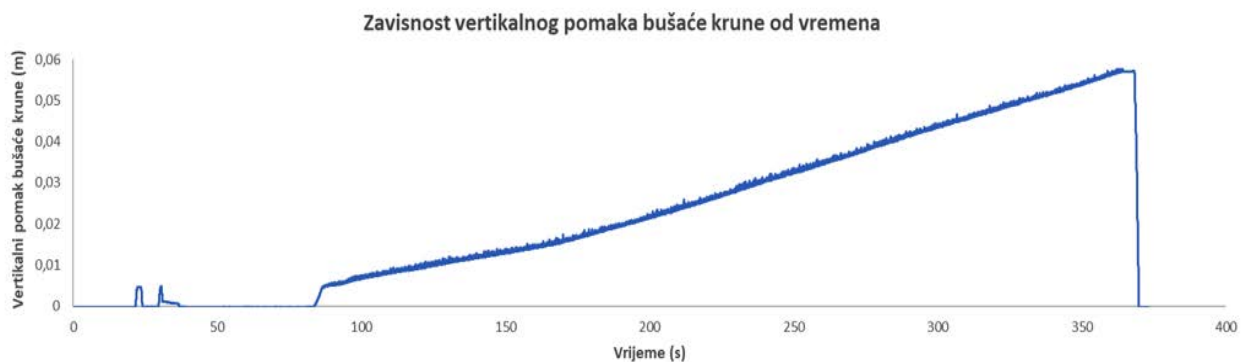
Slika 4.7. Dijagram zavisnosti vertikalnog pomaka bušaće krune od vremena za uzorak U03-B1
