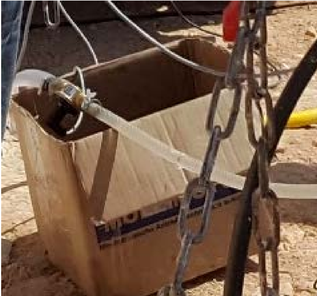
Slika 3.66. Osjetilo za mjerenje protoka spojeno na plastični cjevovod za dovod vode
