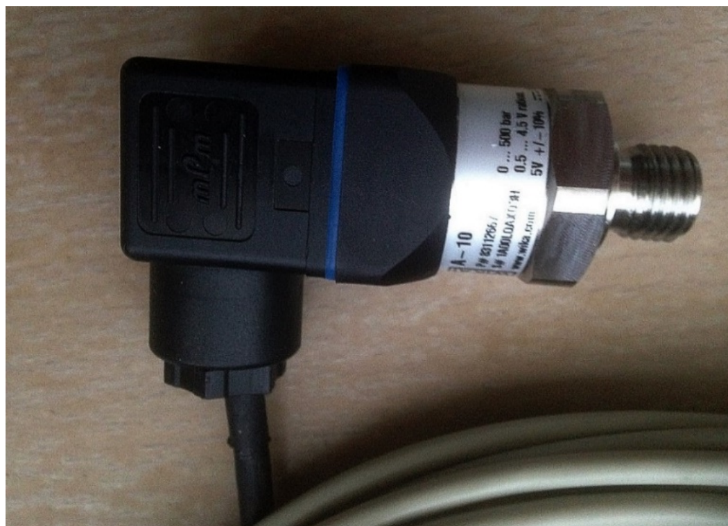
Slika 3.57. Osjetilo za mjerenje tlaka WIKA, Model A-10
