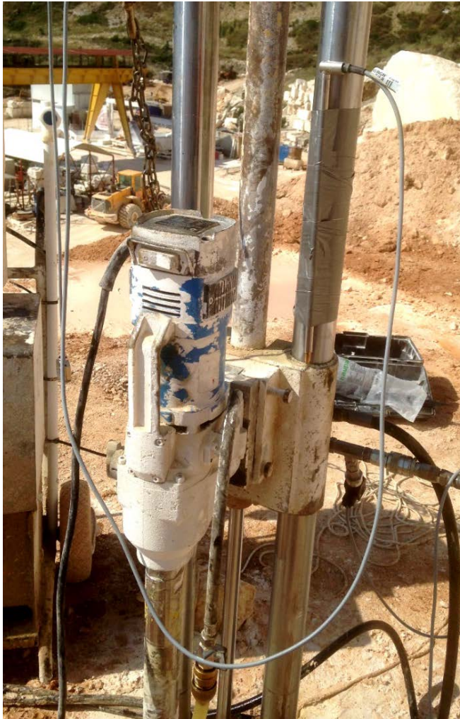
Slika 3.64. LVDT WA100 učvršćen na vodilicu hidraulične rotacijske bušilice
