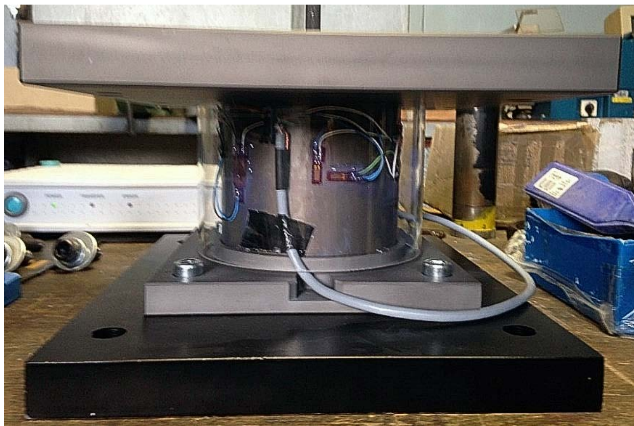
Slika 3.33. Osjetilo za mjerenje vertikalne komponente sile bušenja i okretnog momenta
