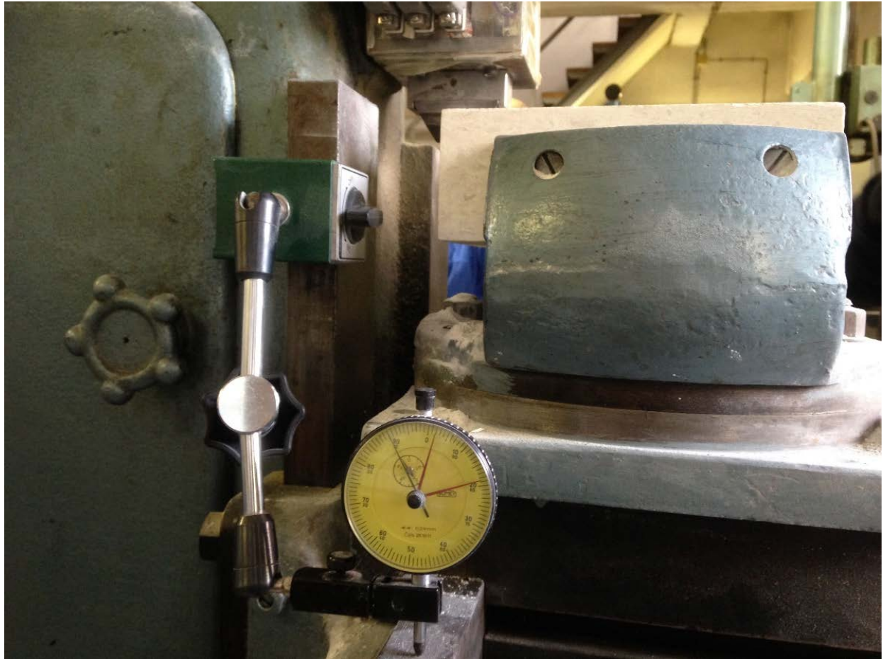
Slika 3.26. Mikroura koja pokazuje namještenu dubinu rezanja reznog elementa od 100 \mu\text{m}
