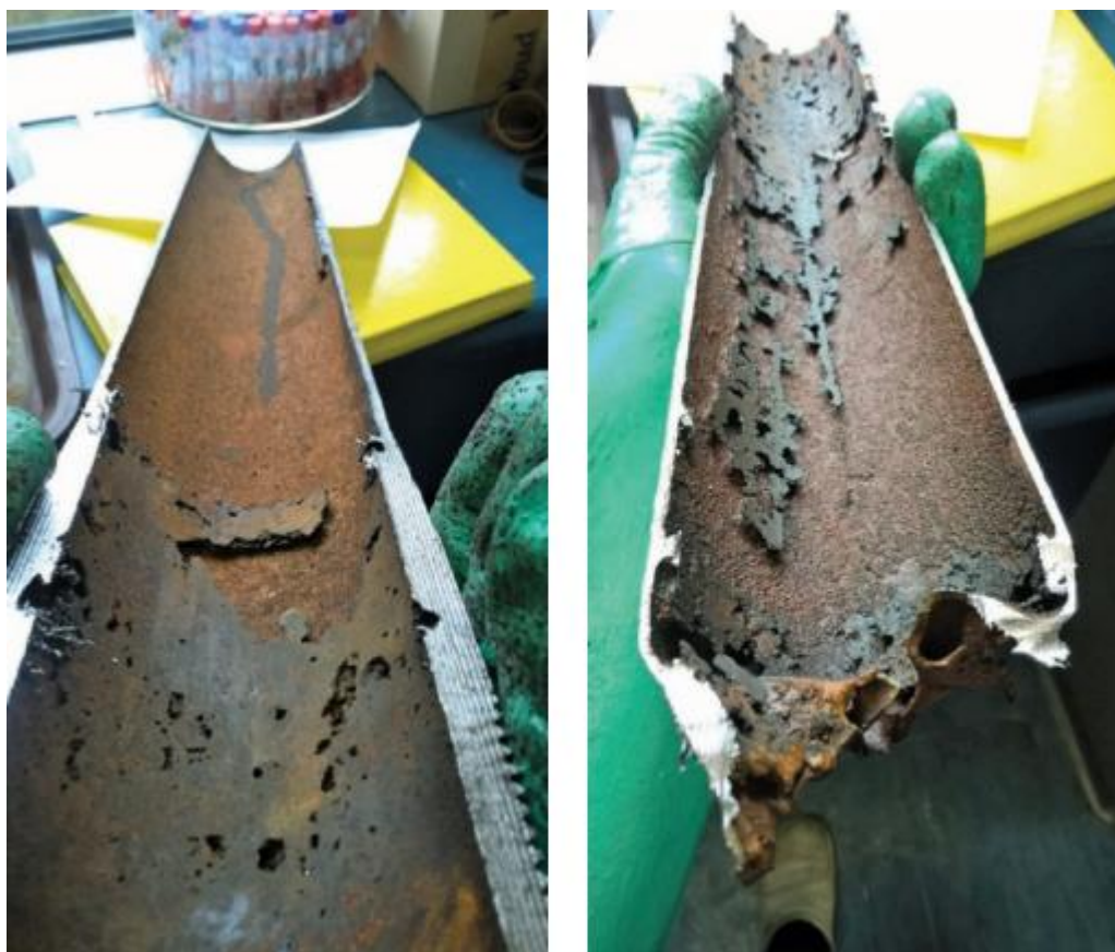
Slika 3-2. Izgled proizvodnog niza sa bušotine Iva-X koja proizvodi naftu, s udjelom CO 2 od 36,5% (Jelić Balta & Borko, 2018)
