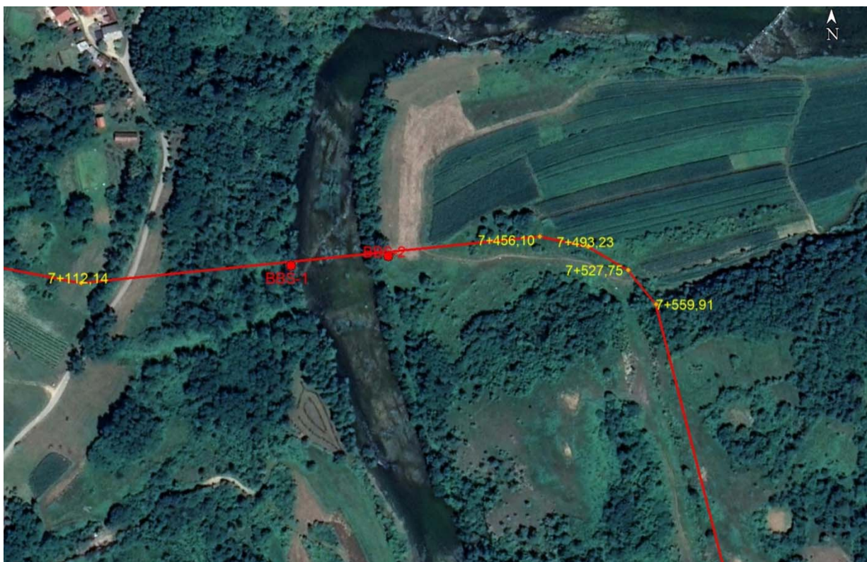
Slika 4-8 Pregledna karta područja trase magistralnog plinovoda Bosiljevo-Sisak DN 800/100 s ucrtanim pozicijama bušotina na prijelazu trase preko rijeke Dobre
