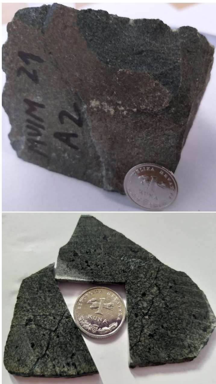
Slika 5-4. Uzorak MVIM 21A2 (gore). Fotografija pločice od koje je napravljen mikoskopski preparat (dolje).
