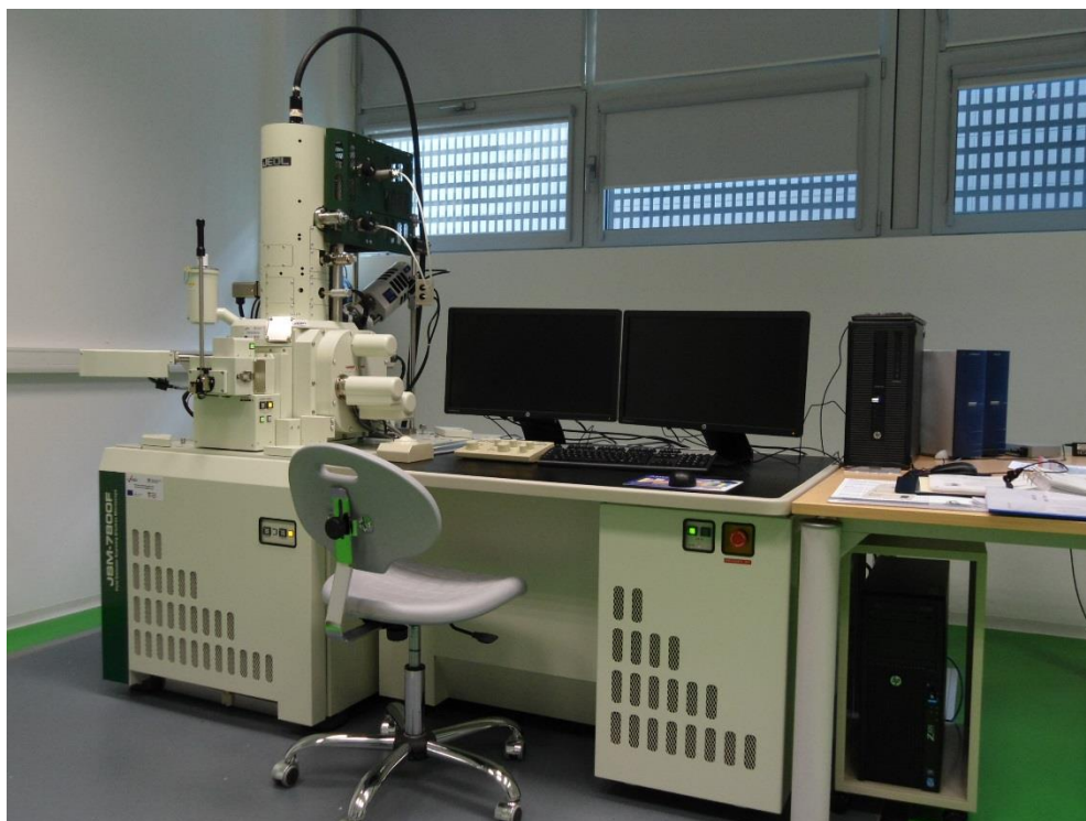
Slika 4-1 Skenirajući elektronski mikroskop (SEM) (Sveučilište u Rijeci, 2010)
