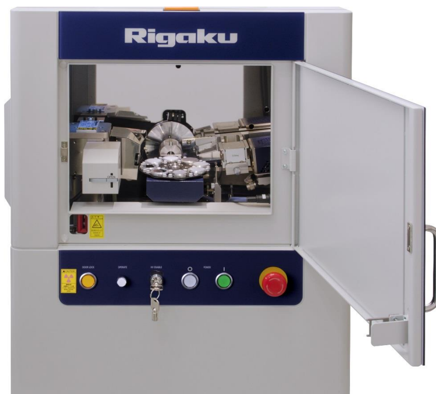
Slika 5-2 XRD MiniFlex je rendgenski difraktometar (ROFA d.o.o., 2019)
