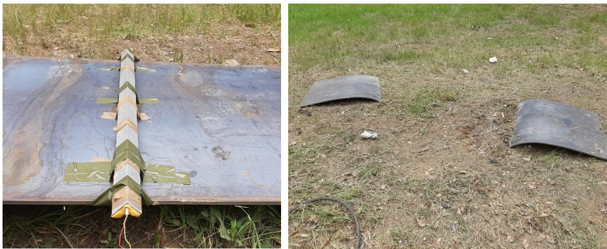
Slika 3-12. Rezanje metalne ploče primjenom linijskog kumulativnog rezača.
