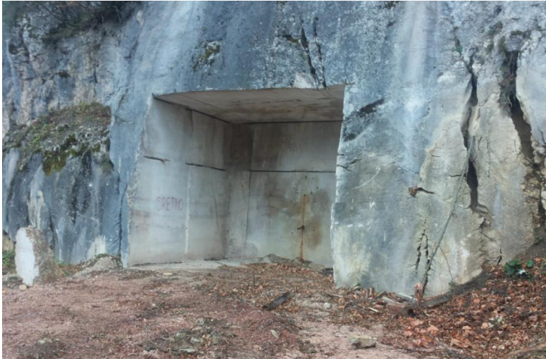
Slika 4-1 Istražna galerija na ležištu a-g kamena Crvene Stijene (Dragičević i dr., 2015).
