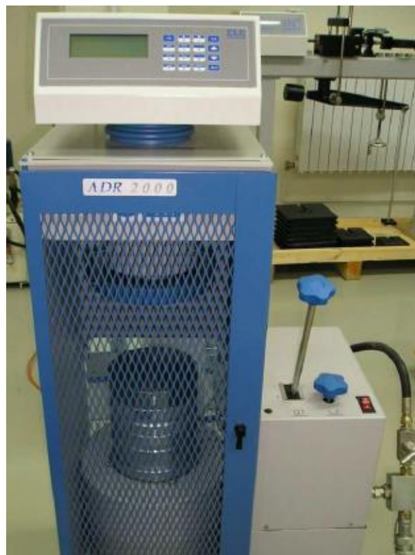
Slika 4-9 Hidraulična preša ELE ADR 2000 (Hrženjak i Briševac, 2009)
